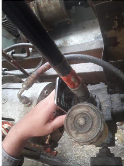
Figura 2-6: Toma de señales de emisiones acústicas en campo (Fuente Propia)
