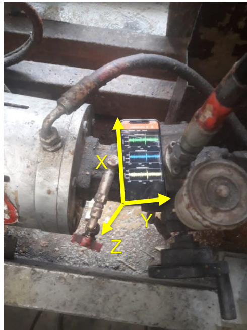
Figura 2-2: Toma de señales de vibraciones en campo (Fuente Propia)
