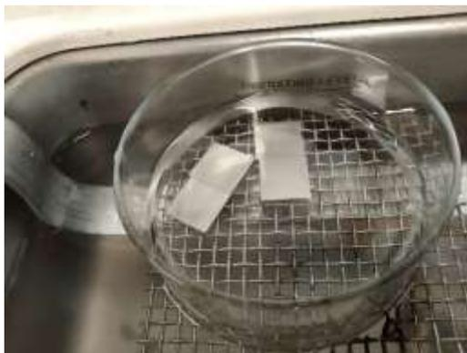
**Figura 3.** Limpieza de muestras en baño de ultrasonido
