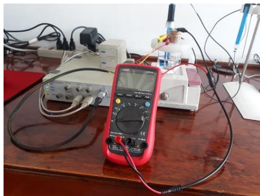
Figura 2-1. Montaje de titulación coulombimétrica de las fibras oxidadas. En primer plano: multímetro. Segundo plano: potenciostato, agitador, electrodo de pH y celda de reacción en funcionamiento.
