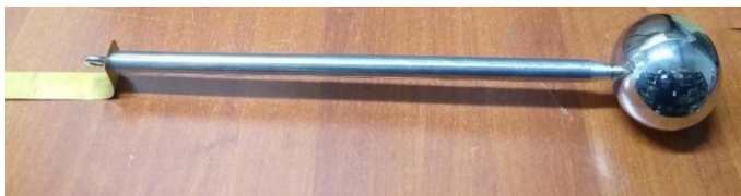
Figura 3-9: Ensamble completo de fleje de bronce, tornillo de sujeción, vástago y esfera
