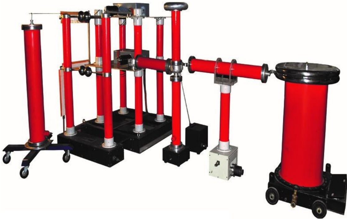
Figura 2-2: Explosores de esfera en un generador de impulsos
