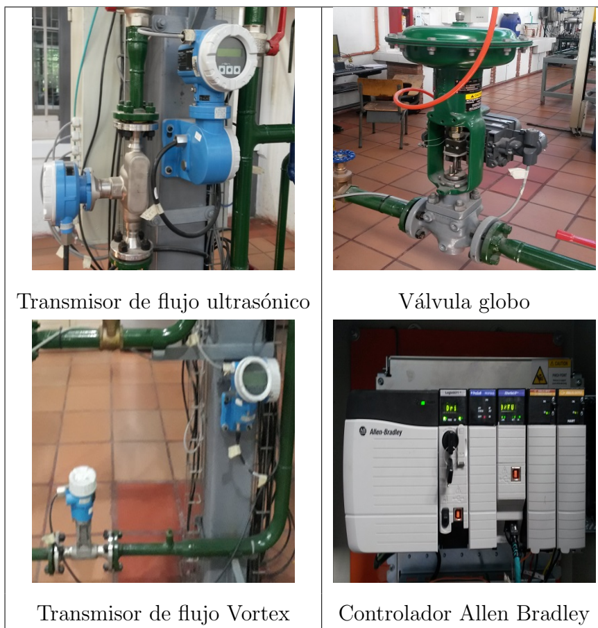
Figura 3-2.: Instrumentos del lazo de flujo del laboratorio LISC.
