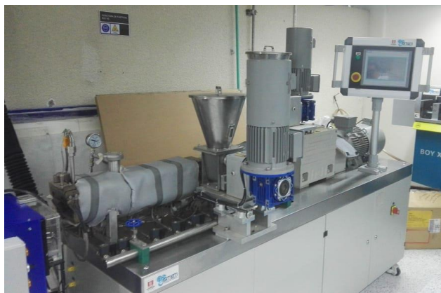
Figura 1. 5. Equipo de extrusión empleado en el procesamiento de polímeros.
