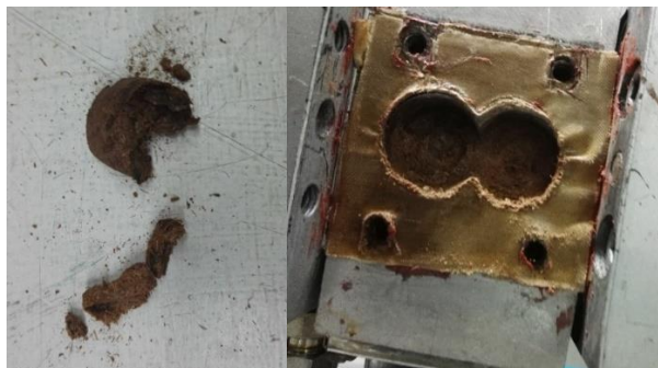
Figura 1. 13. Evidencias de la salida del alimentador de fibra obstruido.
