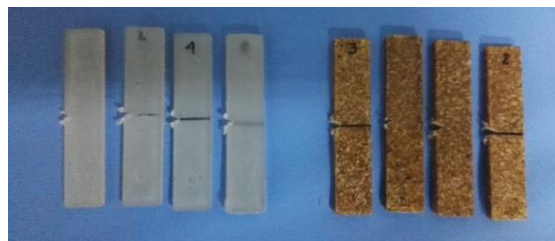
Figura 2. 9. Probetas empleadas en el ensayo de impacto.
