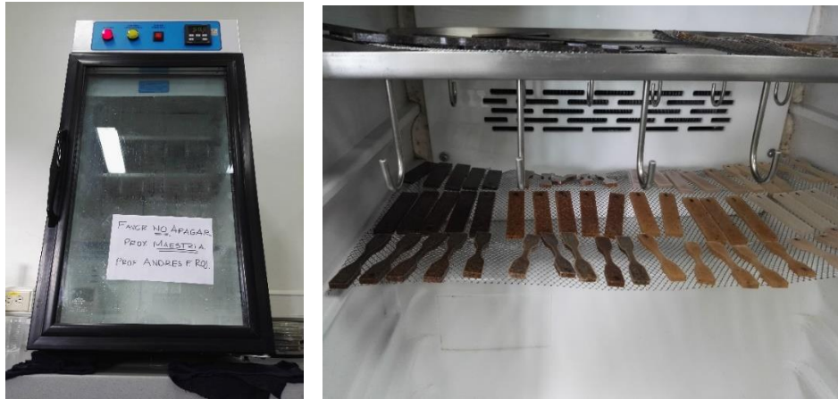
Figura 3. 2. Montaje utilizado para el ensayo de envejecimiento acelerado.
