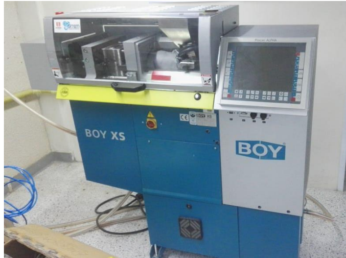
Figura 2. 5. Equipo de inyección empleado para la obtención de probetas en ensayos mecánicos.
