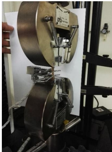
Figura 2. 7. Montaje de probeta para ensayo de tracción.
