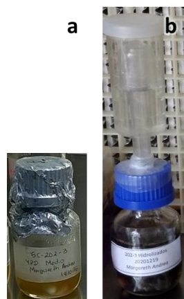
Figura 2-1 – Frascos utilizados en los crecimientos y fermentaciones. a) Frasco tapa rosca con medio YPD y b) Frasco con sistema airlock con hidrolizado.
