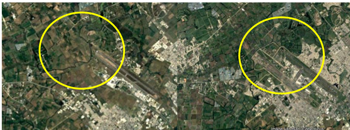
Figura 4-5. Imágenes del cambio del cauce natural del río para la construcción de la pista del aeropuerto. Imagen 1 corresponde a 1985. Imagen 2 corresponde a 1998.
