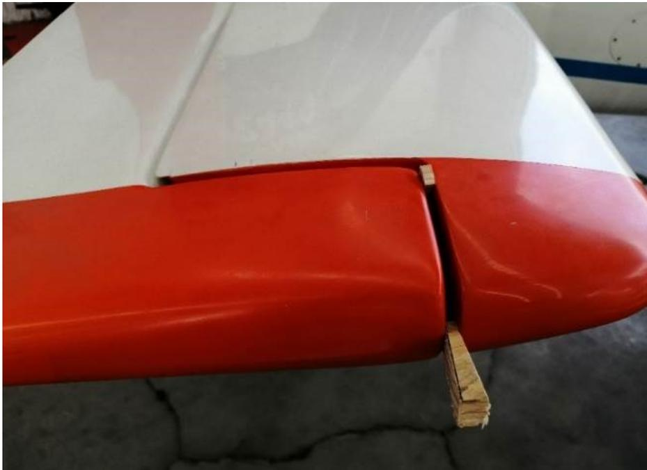
**Figura 3-2.:** Bloqueo de las superficies de control
