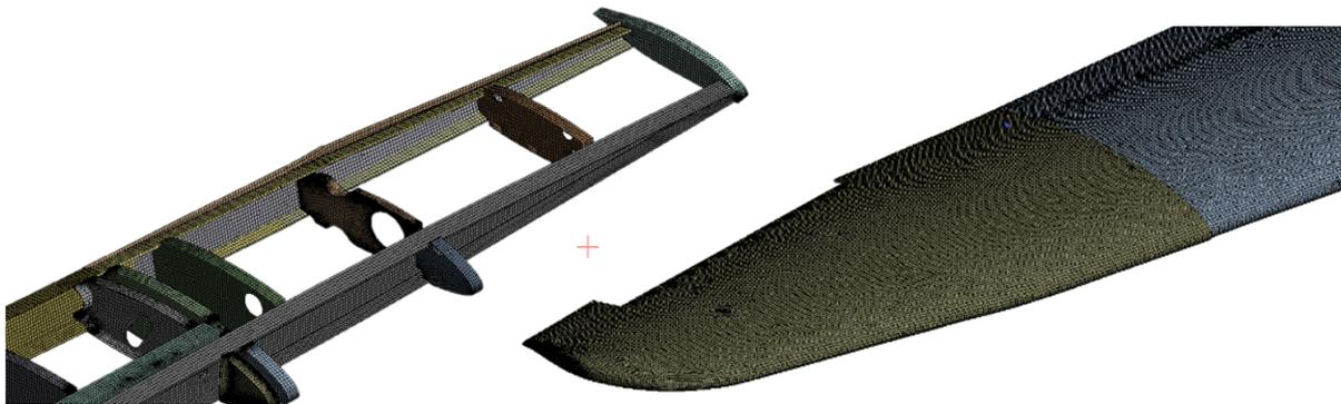
Figura 4-17.: Esquema de enmallado
