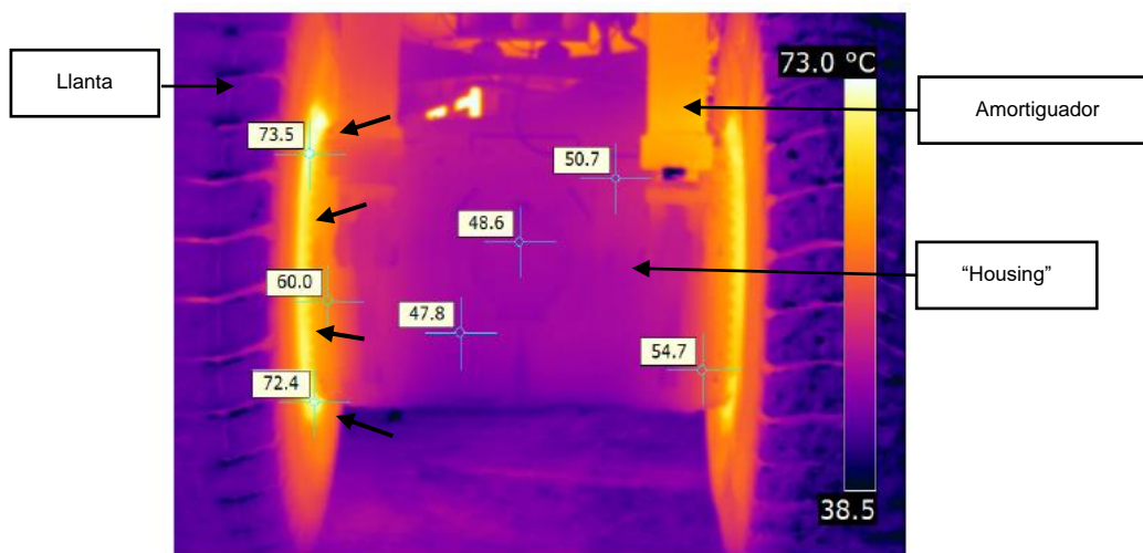
Figura 2-20: Cromatografía en “Housing”.
