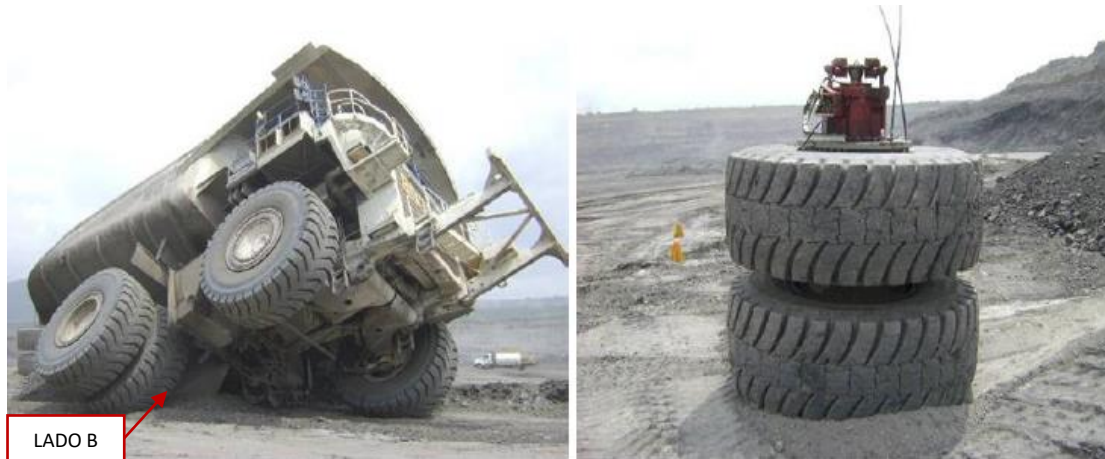
Figura 2-35: Estado del camión por fractura del anillo (Lado A).
