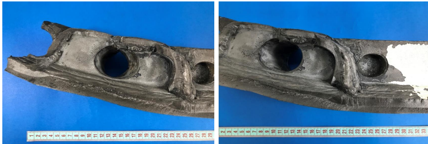
Fotografía D-3: Detalles superficie de fractura – Cilindro interno.
