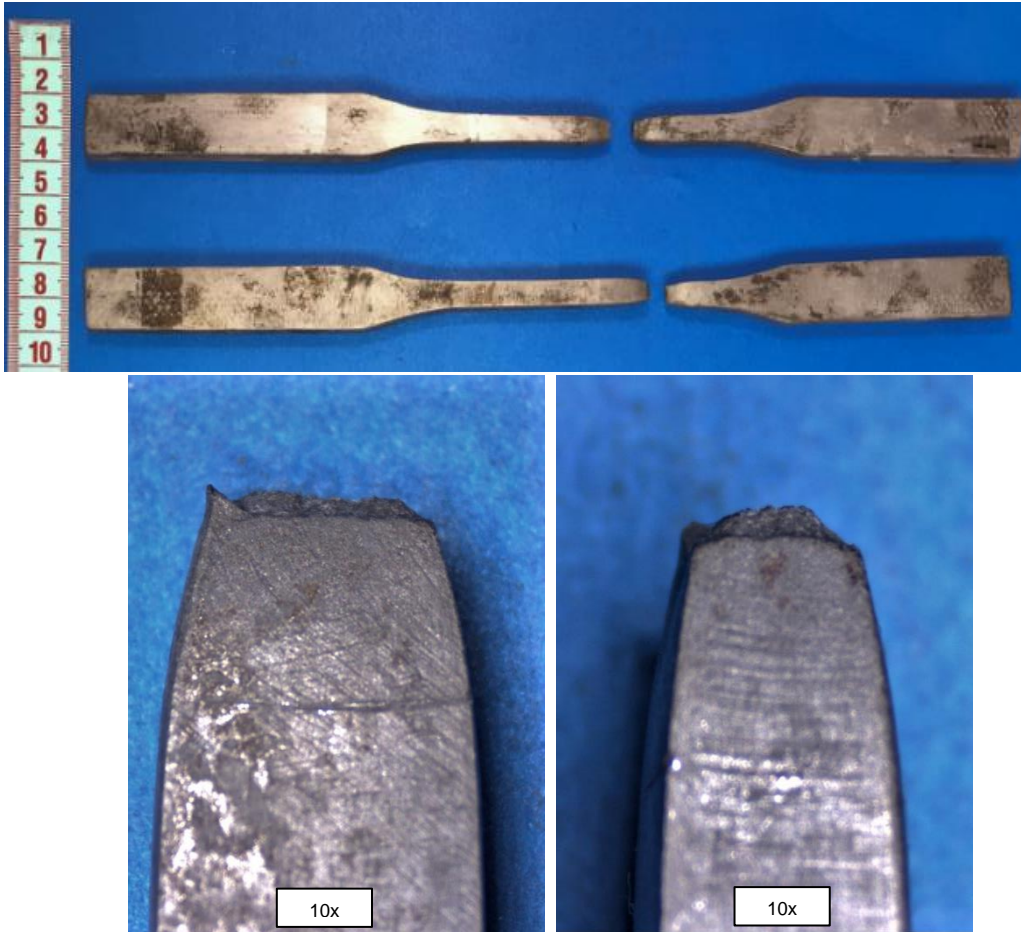
Fotografía G-1: Apariencia de fractura - "Housing" (H1, H2).
