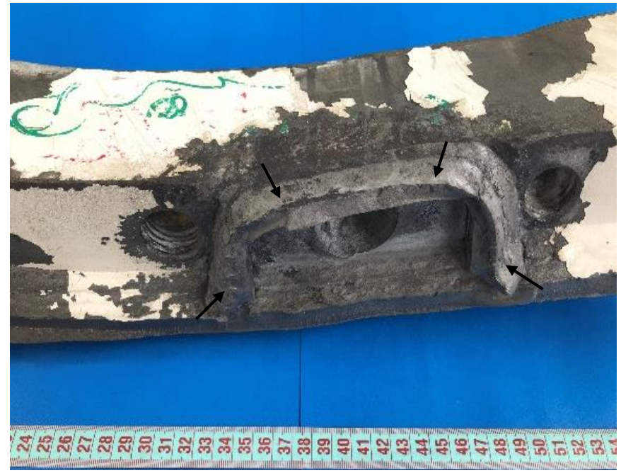
Fotografía F-1: Detalles cordones de soldadura fracturados – unión “Channel” - Brida.
