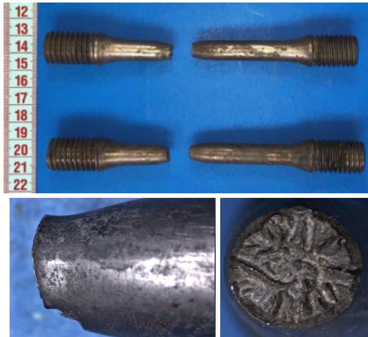
Fotografía G-2: Apariencia de fractura en ensayo de tracción - Tornillos (T1, T2).
