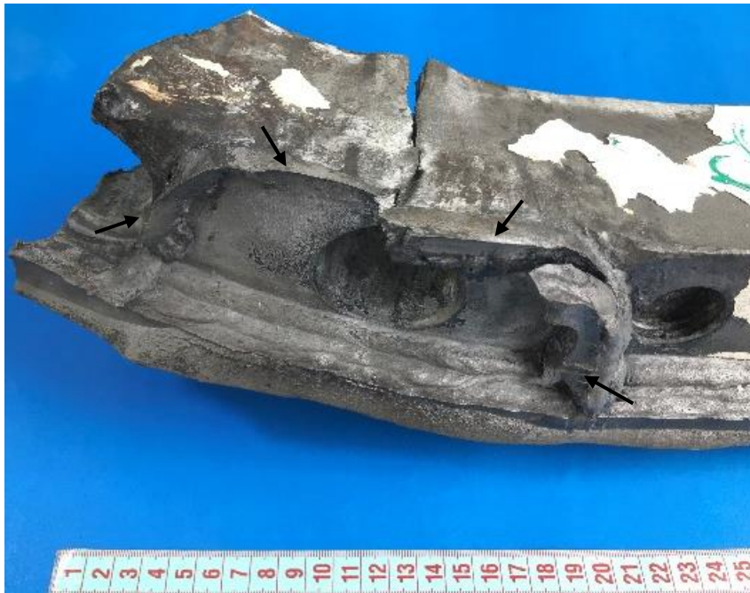
Fotografía F-1: Detalles cordones de soldadura fracturados – unión “Channel” - Brida.
