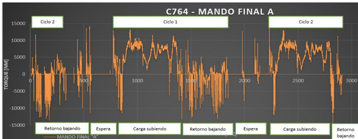
Figura 4-36: Monitoreo de torque para dos ciclos de operación.
