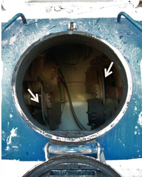
Fotografía C-4: Frenos de disco alojados al interior del "Housing".
