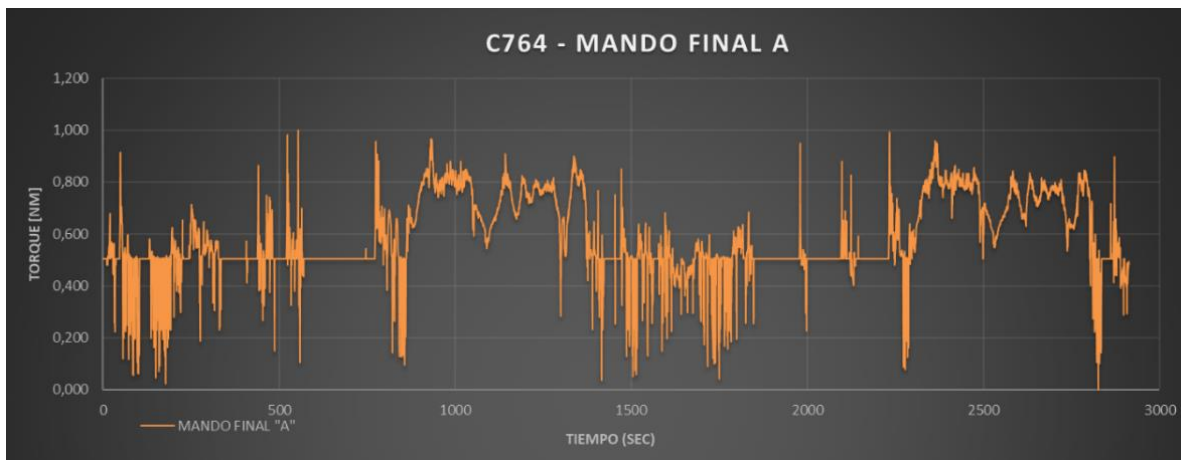
Figura 4-37: Porcentaje de variación de torque para dos ciclos de operación.
