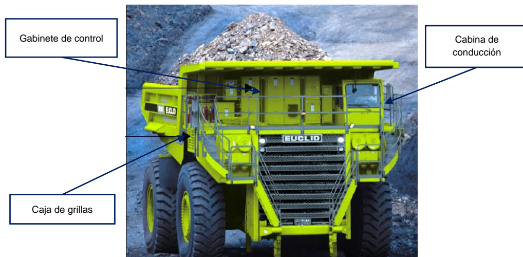
Figura 2-17: Ubicación de cabina de control y resistencias de grillas.
