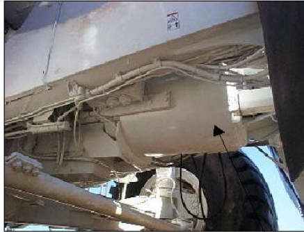
Figura 2-10: Ubicación alternador de tracción.
