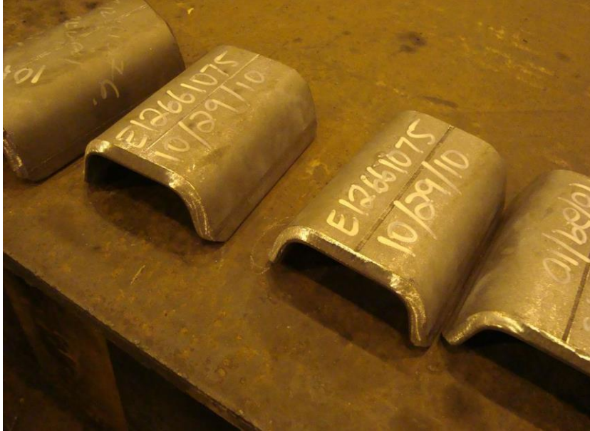
Fotografía C-3: Cambio de "channels".
