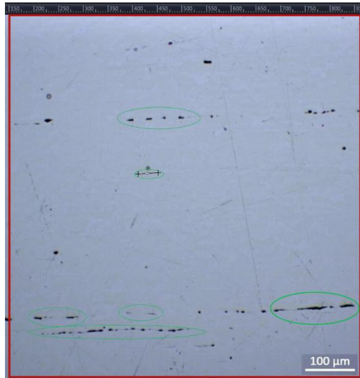
Fotografía L-1: Detalle conteo de inclusiones "Housing".
