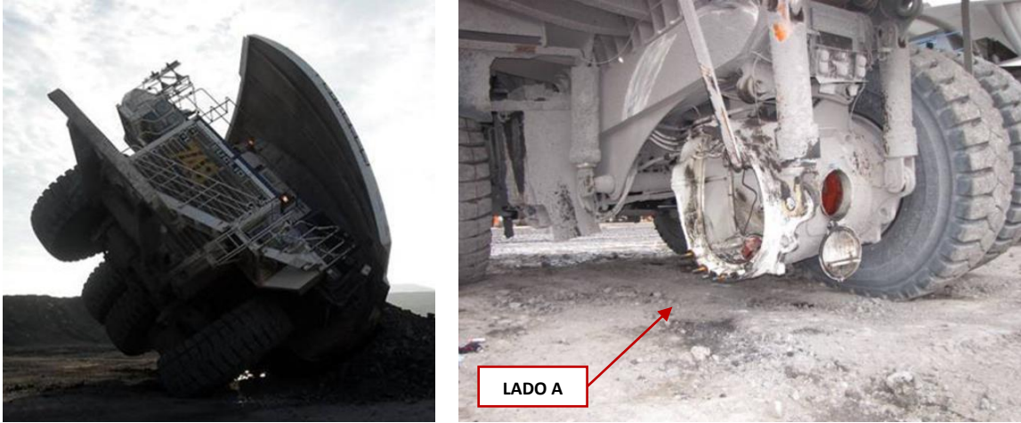
Figura 2-30: Fractura y desprendimiento de anillo y mando final (Lado A).
