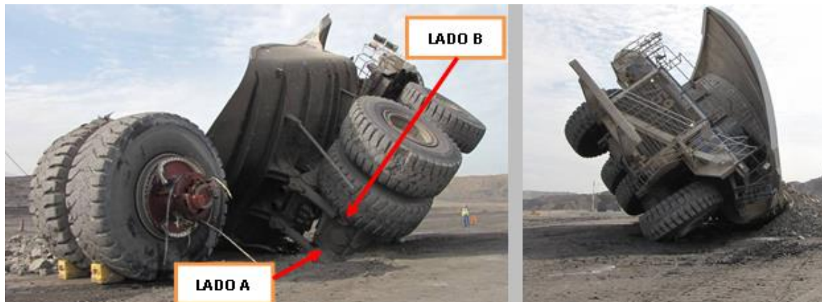
Figura 2-22: Estado del camión por el desprendimiento del mando final.
