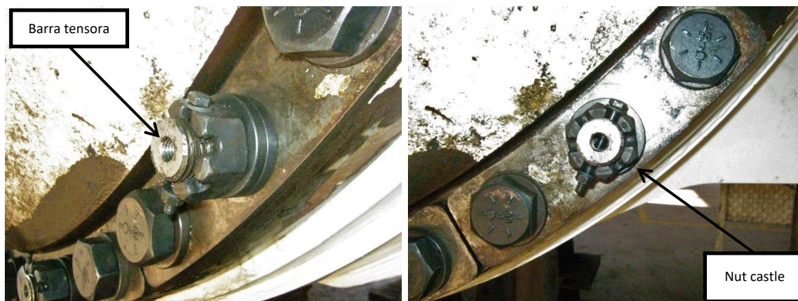
Fotografía N-4: La implementación de Nut castle en barras tensoras como método de fijación al "Housing", permite la pretensión en los mismos.
