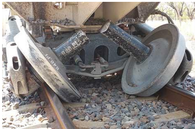
Figura 1.7: Fractura por fatiga en eje ferroviario.
