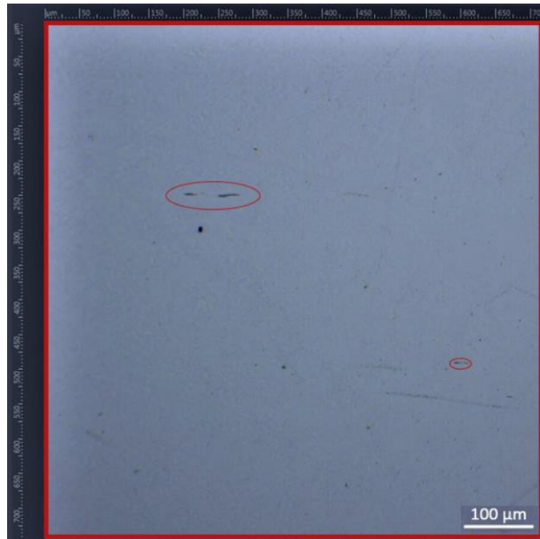
Fotografía L-3: Detalle conteo de inclusiones Tornillo.
