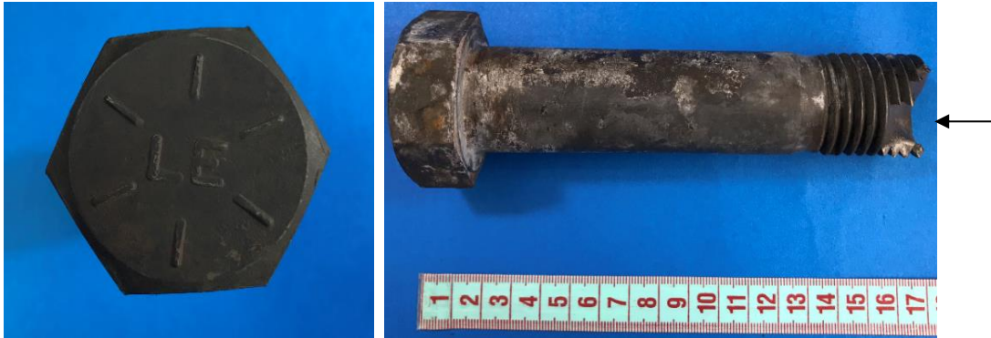
Figura 3.13: Sección de tornillo fracturado.
