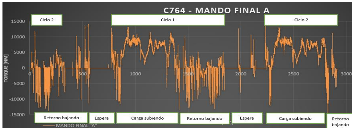
Figura 2-18: Monitoreo de Torque - Camión C764 - Flota 320.
