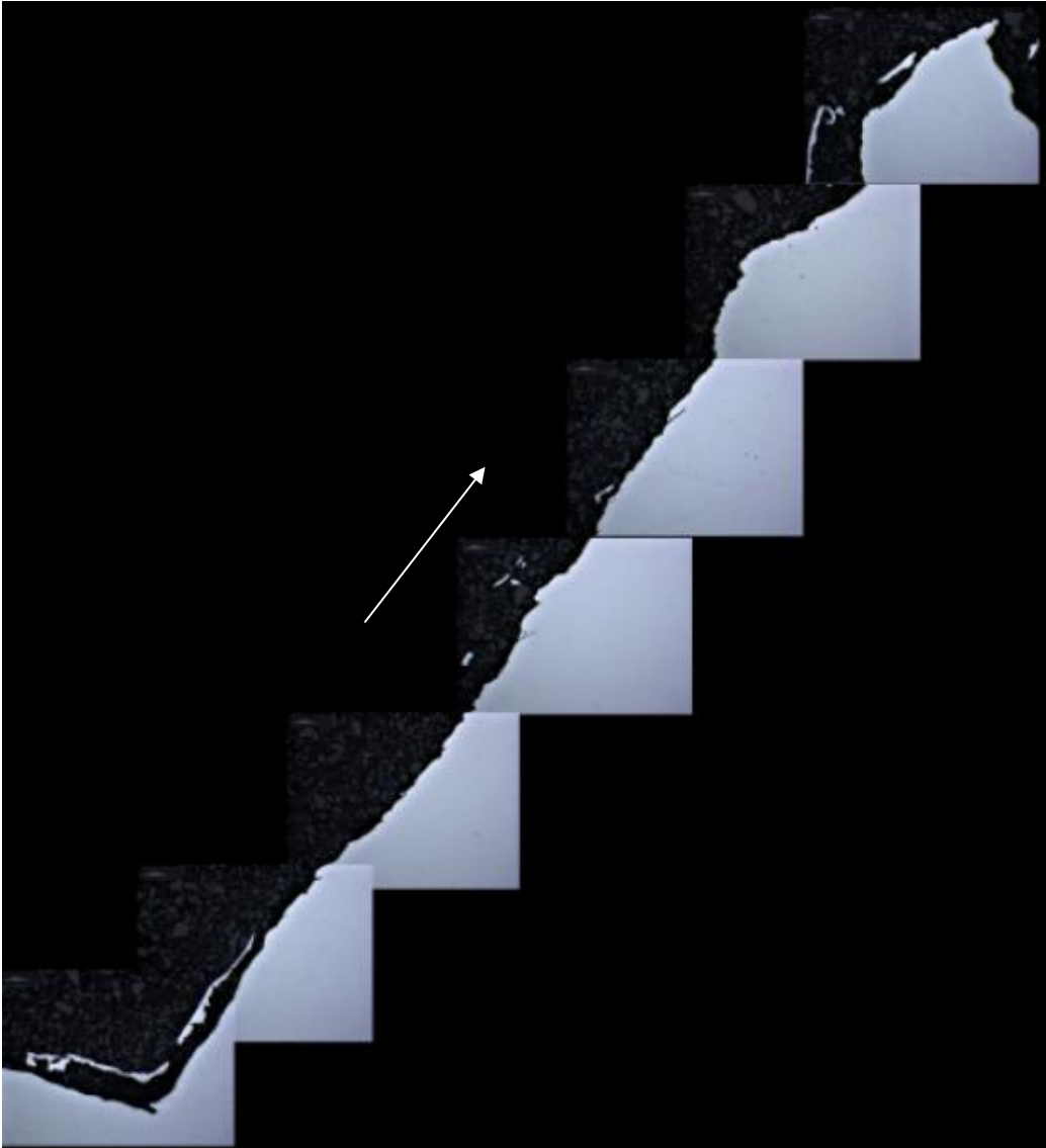
Fotografía K-4: Dirección de propagación de grieta - Sección 2.
