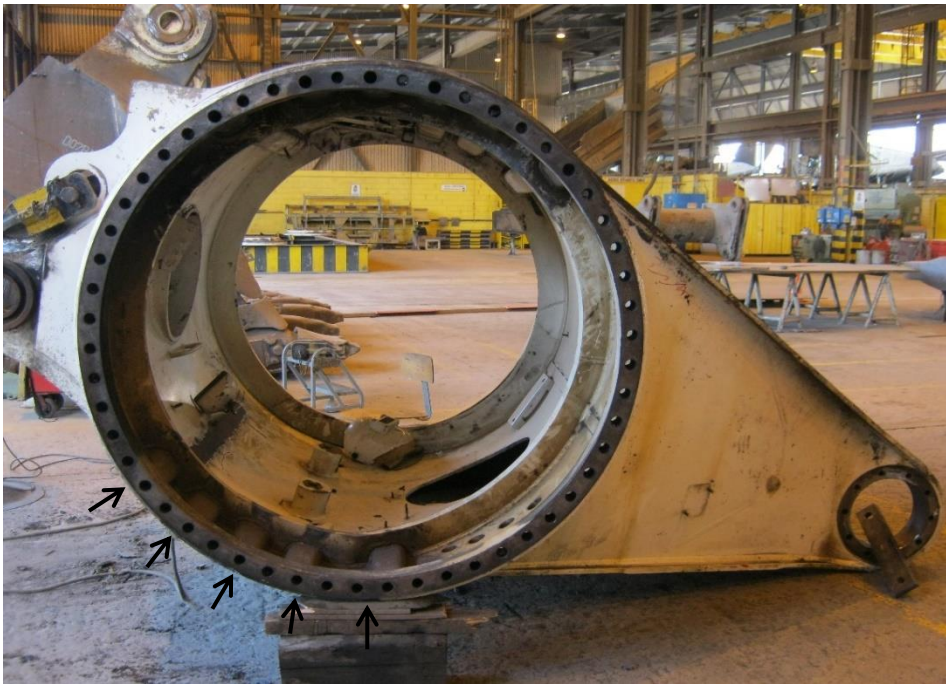
Fotografía C-5: Reparación por agrietamiento y cambio de “channels” de refuerzo en parte alta de “Housing”.
