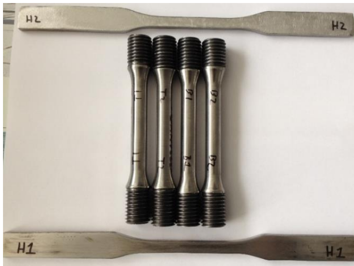
Figura 3.15: Probetas para ensayos de tracción mecánica.
