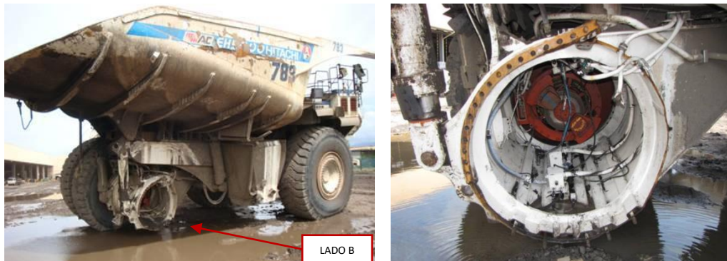
Figura 2-28: Fractura y desprendimiento de mando final de “Housing” (Lado B).
