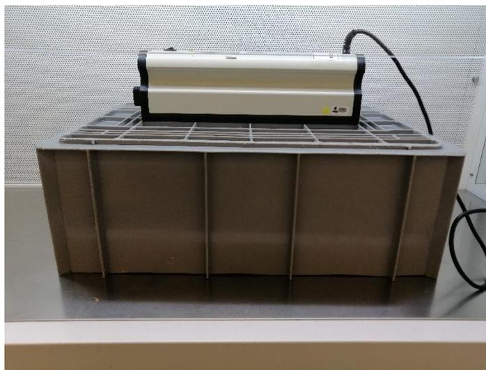
**Figura 3-1.** Montaje de exposición a radiación ultravioleta en condiciones de laboratorio.
