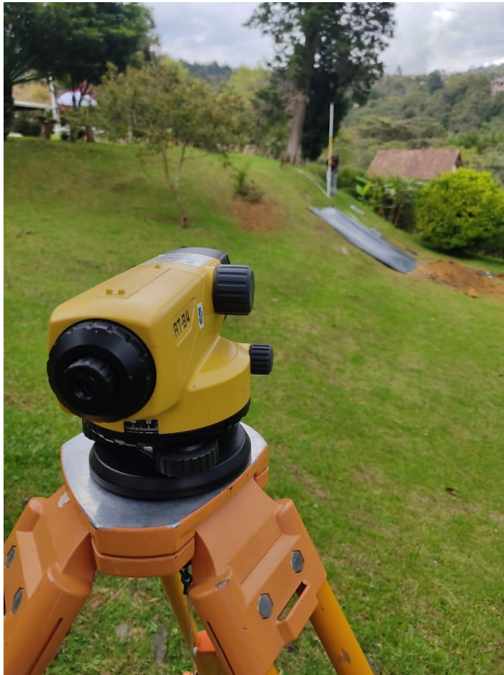
Figura 15. Levantamiento de la parcela de campo con cinta métrica y nivel topográfico
