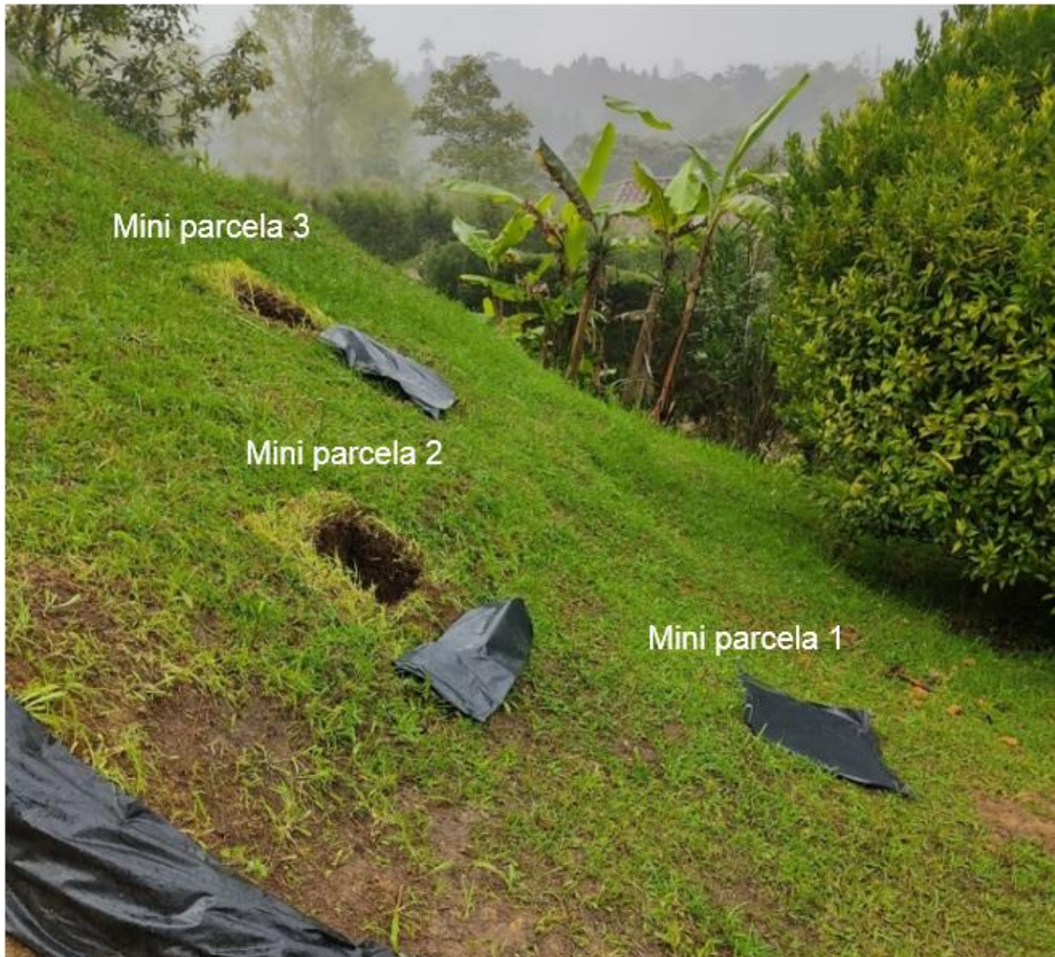
Figura 10. Mini-parcelas ejecutadas para la extracción de muestras inalteradas
