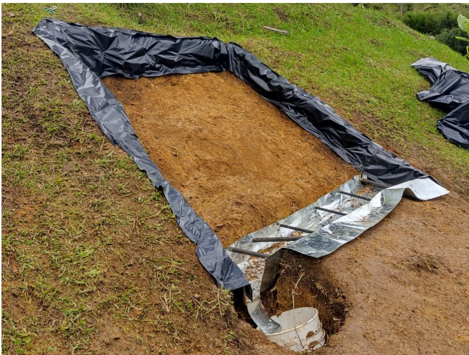
Figura 18. Parcela de prueba - Medida de la erosión en campo
