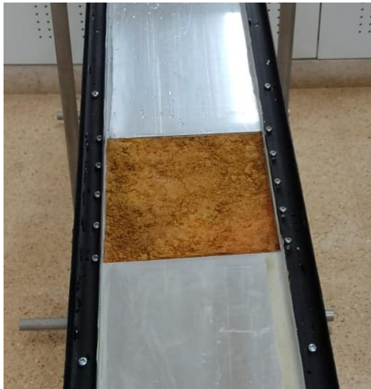
Figura 24. Ensamblaje de la muestra de suelo a la rampa Inderbitzen
