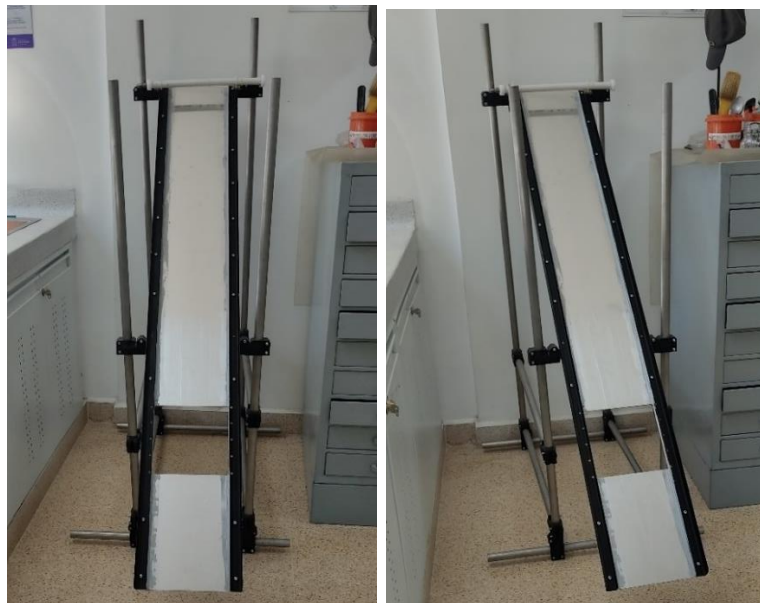
Figura 21. Rampa con orificio cuadrado de lado igual a 20cm
