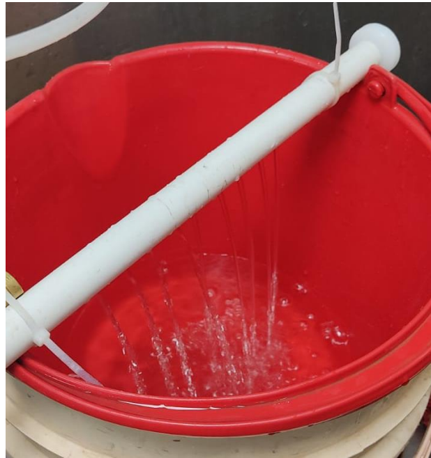
Figura 22. Tubo en PVC perforado para la simulación de la escorrentía superficial
