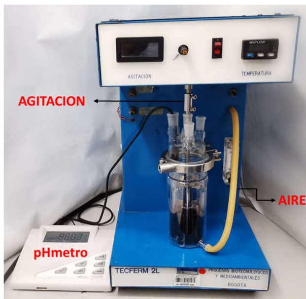
Figura 2-7: Montaje de reacción.
