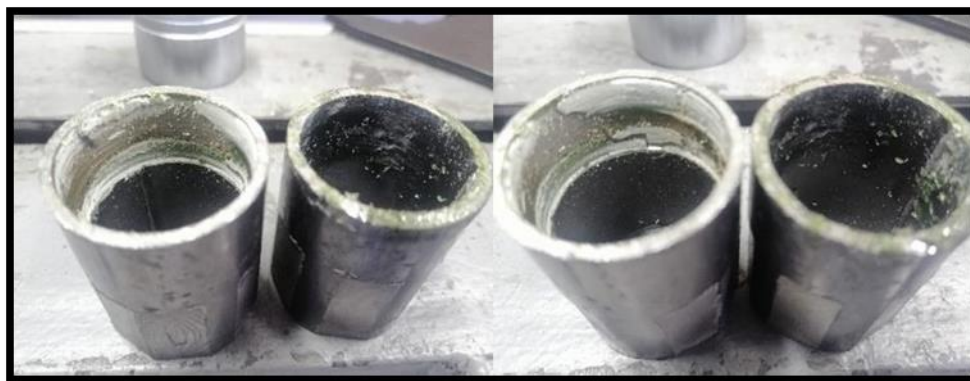
Figura 4-12: Fallas mixtas sobre sustratos de tubería estructural acero ASTM A-36.
