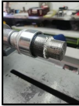
Figura 4-10: Ensayos de torsión en probetas acero-adhesivo-acero con torque 40 ( N \cdot m ).
