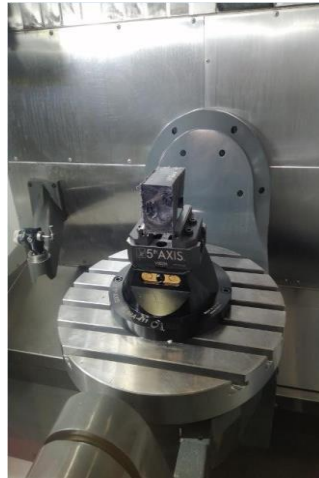
Figura 3-8: Ubicación del bloque del polímero Nylon en el MS de la CNC.
