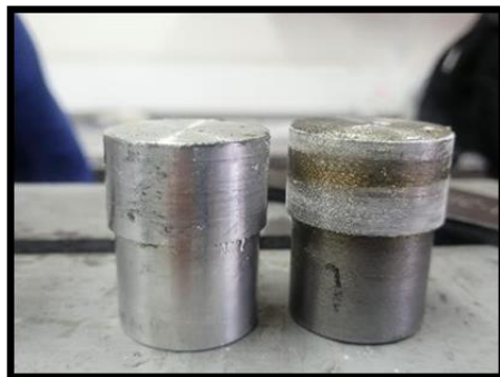
Figura 4-11: Fallas adhesivas sobre sustrato de Dura Aluminio en comparación con Acero durante pruebas de torsión.
