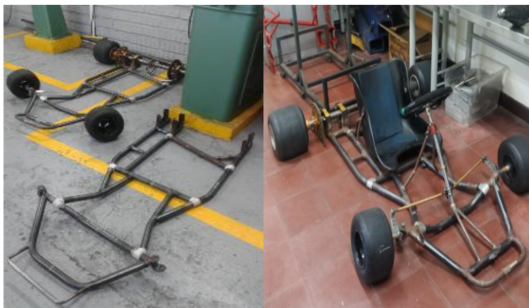
Figura 4-4: Prototipos de chasis ensamblados con uniones adhesivas.
