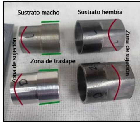
Figura 3-15: Probetas de prueba para la unión adhesiva. Izquierda sustrato A: macho; Derecha sustrato B: hembra (tubería acero).
