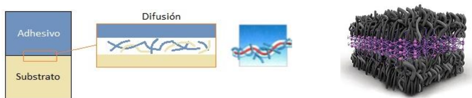
Figura 1-5: Mecanismo de interdifusión de las moléculas de los planos superficiales [28].
