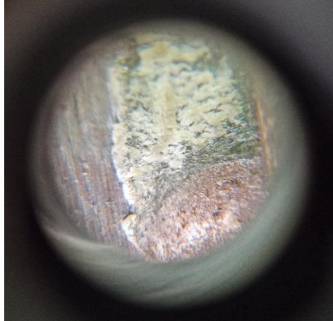
Figura 4-13: Falla adhesiva en la superficie del sustrato Dura Aluminio con parámetro de rugosidad superficial R_a = 1.5 \mu m. , aumento 60X.
