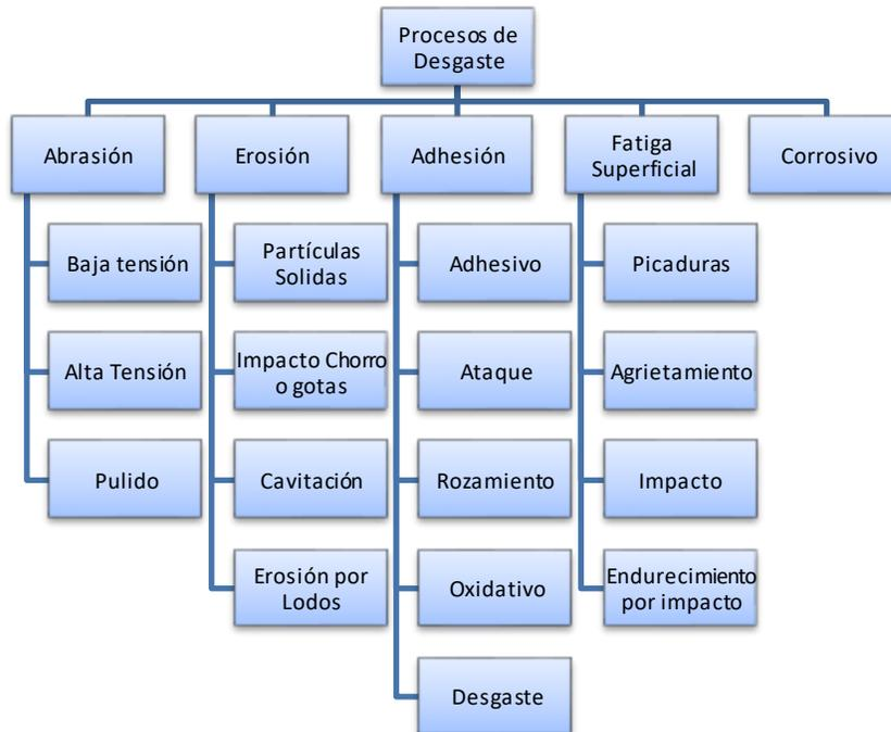
**Figura 1-4:** Diagrama de Flujo de varios mecanismos de desgaste.
