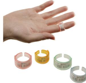
**3-15-3** Detector de lectura diferida de extremidades. Imagen tomada del proveedor del detector.
