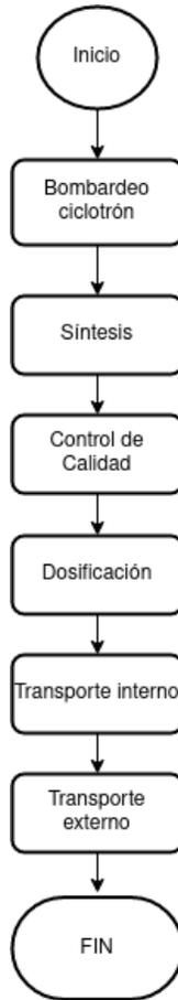
Figura 4-3: Proceso para radiofármacos producidos por ciclotrón.
