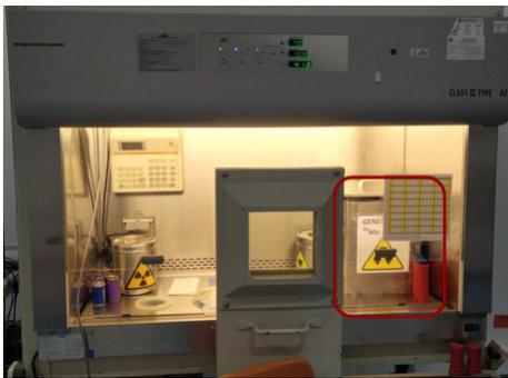
**3-6-1** Cabina de flujo laminar blindada, el recuadro rojo muestra la ubicación del generador dentro de la cabina.
