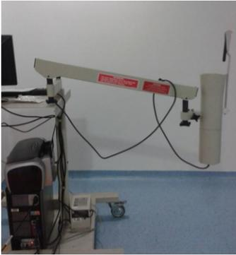
**3-13-1** Gamma sonda-Captus 3000. detector de NaI(Tl) con tamaño de  $5.1 \times 5.1$  cm, con tasa máxima de conteo de 100 000 cps.
