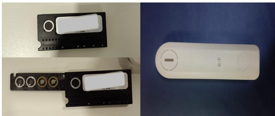
**Figura 3-2.:** Izquierda: Modelo del TLD utilizado. Derecha: Dosímetro de lectura directa.
