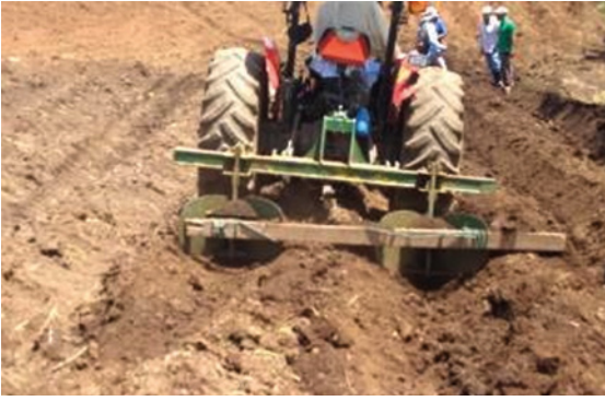
Figura 18. Surcadora-aporcadora de 2 brazos rígidos para la construcción de calles y camas
