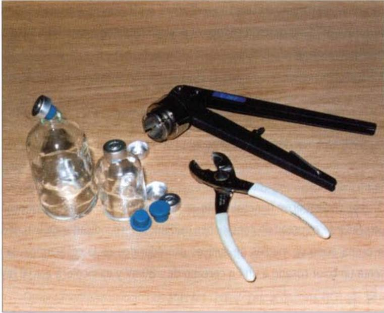
Figura 5.8. Material de vidrio: agrafador, desagrafador, tapones, agrapes y viales de cultivo.
