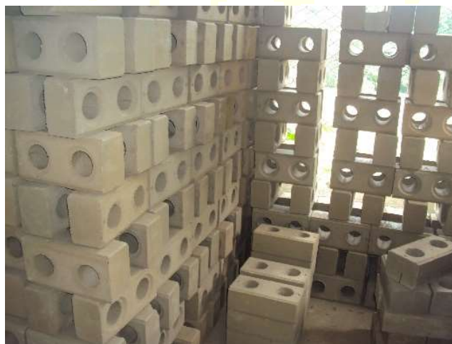
Figura 1. Bloques de suelo cemento confeccionados con prensa mecánica (V1).
