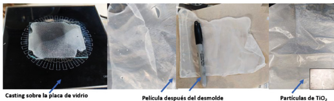
Figura 43. Proceso de casting hasta la obtención de las películas de PLA/TiO 2 -Zn/Bergamota
