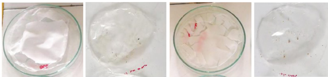
Figura 56. Películas de PLA MC-Funcionalizada en THF y CHCl 3 , siendo de izquierda a derecha THF MC-Ole 1 %, CHCl 3 MC-Ole 1 %, THF MC-Lau 1 % y CHCl 3 mc-Lau 1 %
