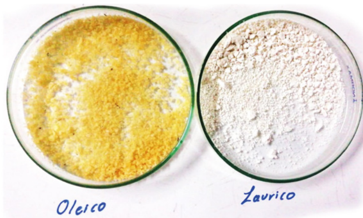
Figura 53. MC-Ole y MC-Lau sintetizadas para el uso en películas de PLA
