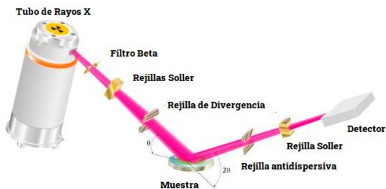
Figura 3-2. Diagrama del tubo de rayos X, muestra y el detector. Adaptado de [163].
