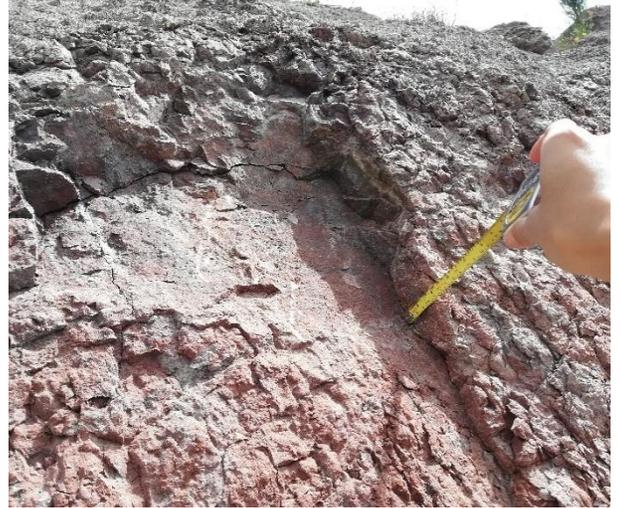
b) Roca afectada por la meteorización por desleimiento (5 cm)
