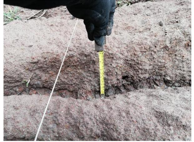
b) Capa de material particularizado en la parte alta del talud (12 cm)
