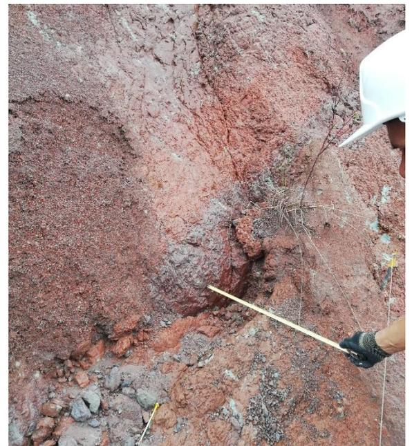
c) Roca afectada por la meteorización por desleimiento (35 cm).
