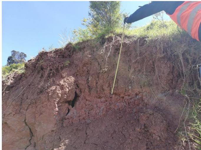
b) Espesor del material particularizado en la berma superior del talud
