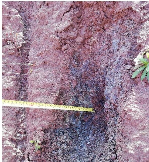
b) Arcillolita afectada por la acción del desleimiento (13 cm).
