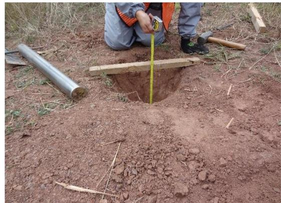
d) Extracción y medición del segundo tubo Shelby hincado
