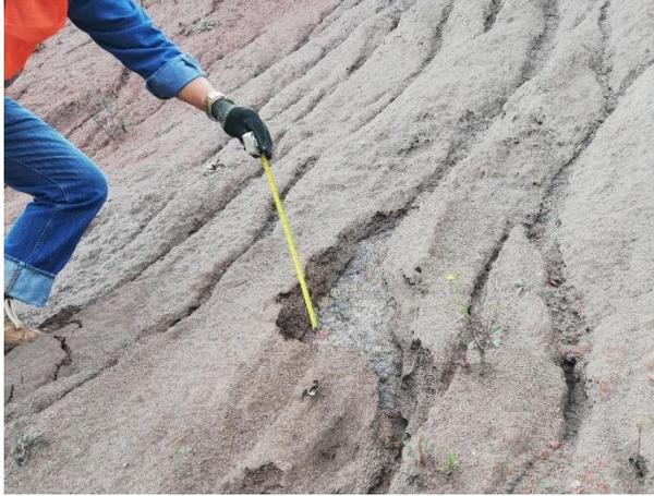
a) Capa de material particularizado en parte media de la cara del talud (14 cm)
