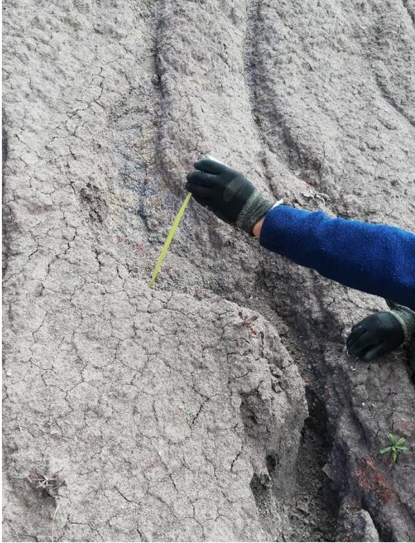
a) Capa de material particularizado en parte media de la cara del talud (7.5 cm)
