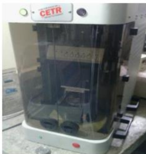
Figura 3-5: Equipo de ensayo de Pin on Disc CETR usado para la medición de las pruebas tribológicas. Fuente [69].
