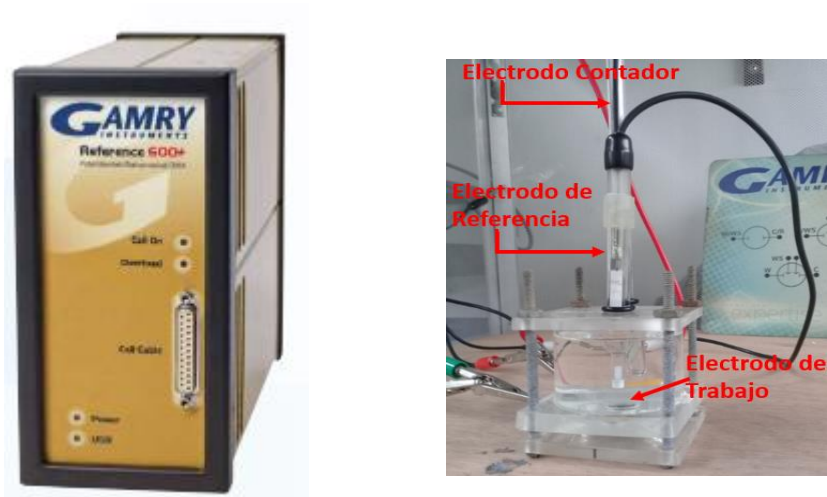
Figura 3-4: Potenciostato Gamry 600 [70], equipo utilizado para la medición de las pruebas electroquímicas (izquierda). Celda electroquímica empleada para la ejecución de las pruebas, con la disposición de 3 electrodos (derecha), fuente(El Autor).
