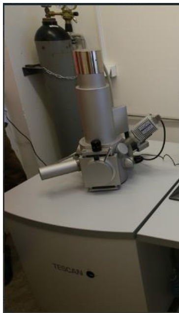
Figura 3-2: Imagen del microscopio electrónico de barrido, modelo Tescan Vega 3 [68].
