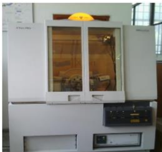
Figura 3-3: Equipo de difracción de rayos X Expert-Pro, utilizado en el estudio. Fuente [69].
