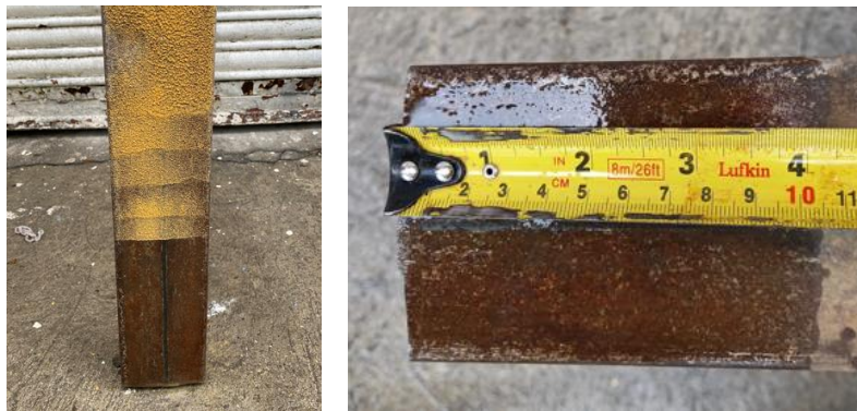
Fotografía 2-22 y Fotografía 2-23: Limnímetro para medición de niveles dentro del tanque construido con varas metálicas.
