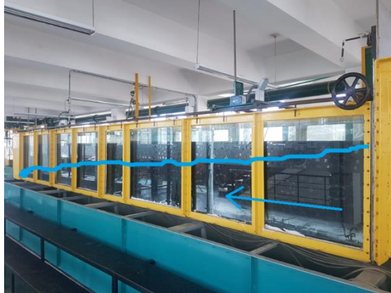
Fotografía 0-1: Representación de la variación del nivel de agua, en el interior de un tanque de detención con elementos celulares instalado en un canal horizontal del LEH-UN.
