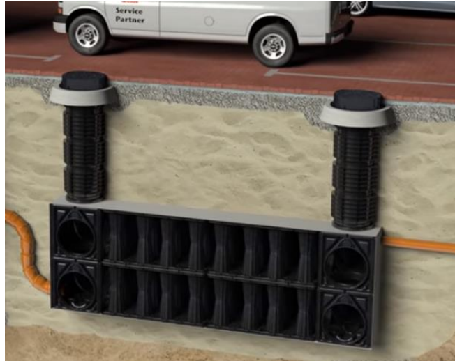
Figura 1-2: Esquema de un tanque de detención con elementos celulares. Fuente: (ACO DRAIN, 2015)
