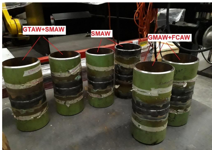
Figura 2-4. Niples soldados con dos juntas para cada proceso.
