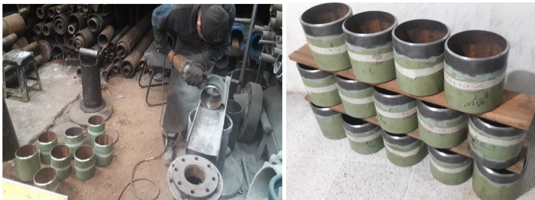
Figura 2-3. Niples de tubería para soldar. API5L X65, 6" de diámetro, SCH 40.
