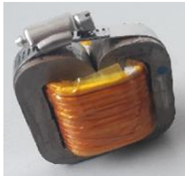
Figura 4-2: Transformador de media frecuencia
