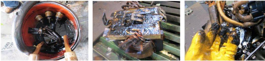
Figura 3-1: Descomposición del aceite aislante en transformadores
