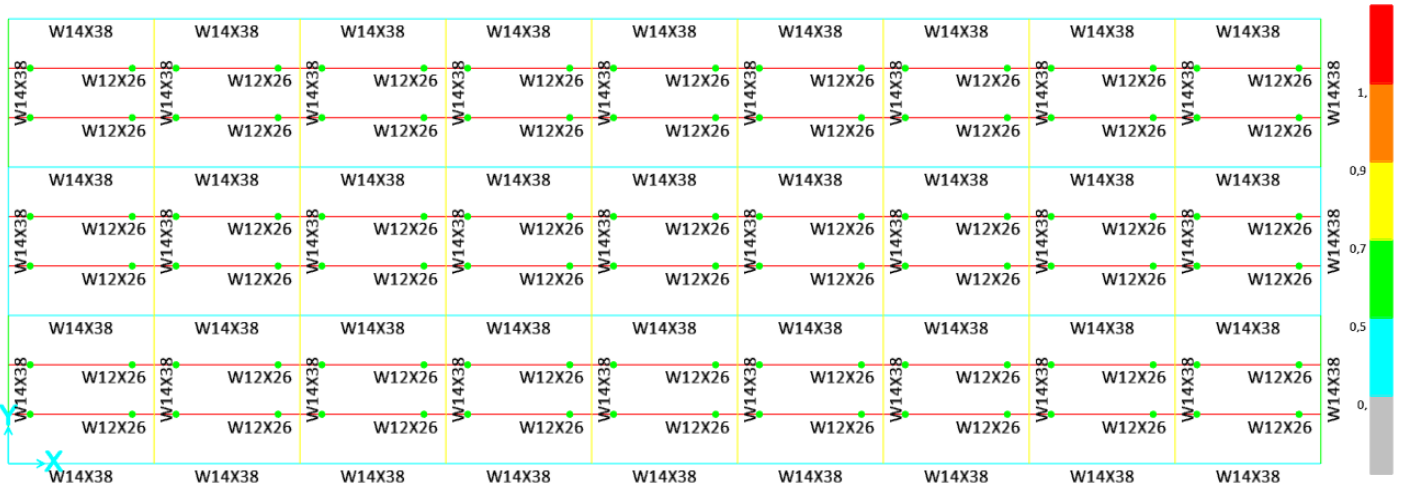
Figura 105 Nivel de estrés en las vigas del segundo piso.
