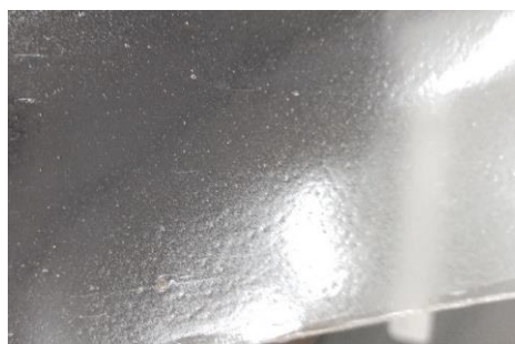
Figura 10. Detalle de película de PLA/cell-acet/comp obtenida por extrusión.
