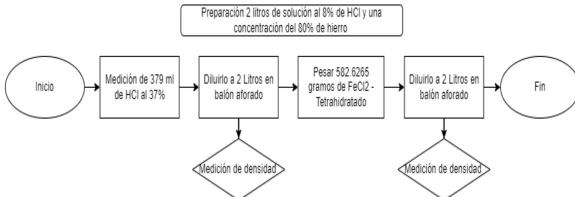
**Figura 8** Procedimiento para preparación de solución simulada de ácidos gastados de decapado
