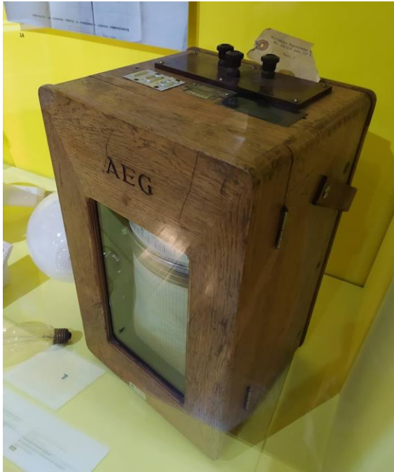
Allgemeine Elektrizitäts-Gesellschaft (AEG) (Ca. 1920). Vatímetro empleado por la Compañía de Energía Eléctrica de Bogotá. Fabricación industrial. Grupo de Energía de Bogotá. Colección Museo de Bogotá.
