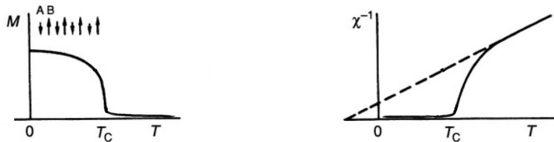
Figura 1-22: Comportamiento de la susceptibilidad magnética y la magnetización para un material ferrimagnético. El ferrimagnetismo es gobernado por la ley de Curie-Weiss [21].
