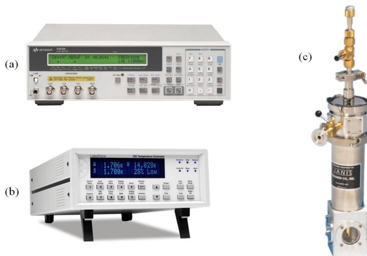
Figura 2-11: Equipos utilizados para la implementación del sistema de medida de las propiedades eléctricas de la familia de materiales R_2AMn_{3-x}Co_xO_9 . (a) Medidor LCR Agilent 4263B. (b) Controlador de temperatura LakeShore Cryotronics 332. (c) Criostato Janis Research ST-100.
