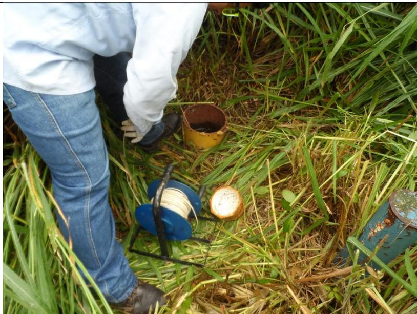
**Imagen 6: Vista parcial procesos de medición de la altura piezométrica – pozo al interior del SDFR Navarro.**
