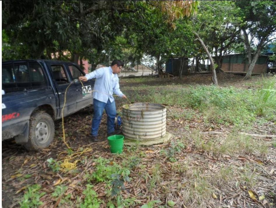
**Imagen 7: Vista parcial procesos de medición de la altura piezométrica – PM-27 externo al SDFR Navarro.**
