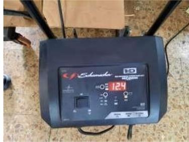
Carga baterías y acepta un voltaje de entrada de 120 Vac, una corriente de entrada de 10A o 48 A, un voltaje de salida de 6V o 12V, una corriente de salida en 6V o 12 V de 2A o 40A, un arranque de motor de 200A. Tiene pantalla digital, indicadores LED y botones de control. (Ideamac, 2022a).
