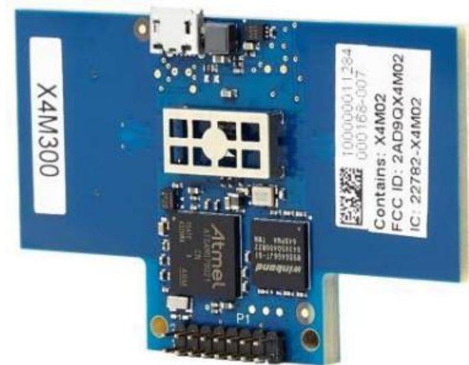
Figura 4-6: Sistema de radar X4M300 [x4m, 2019]
