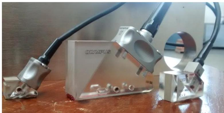
*Figura 19. Palpadores que se tienen para realizar inspección.*
