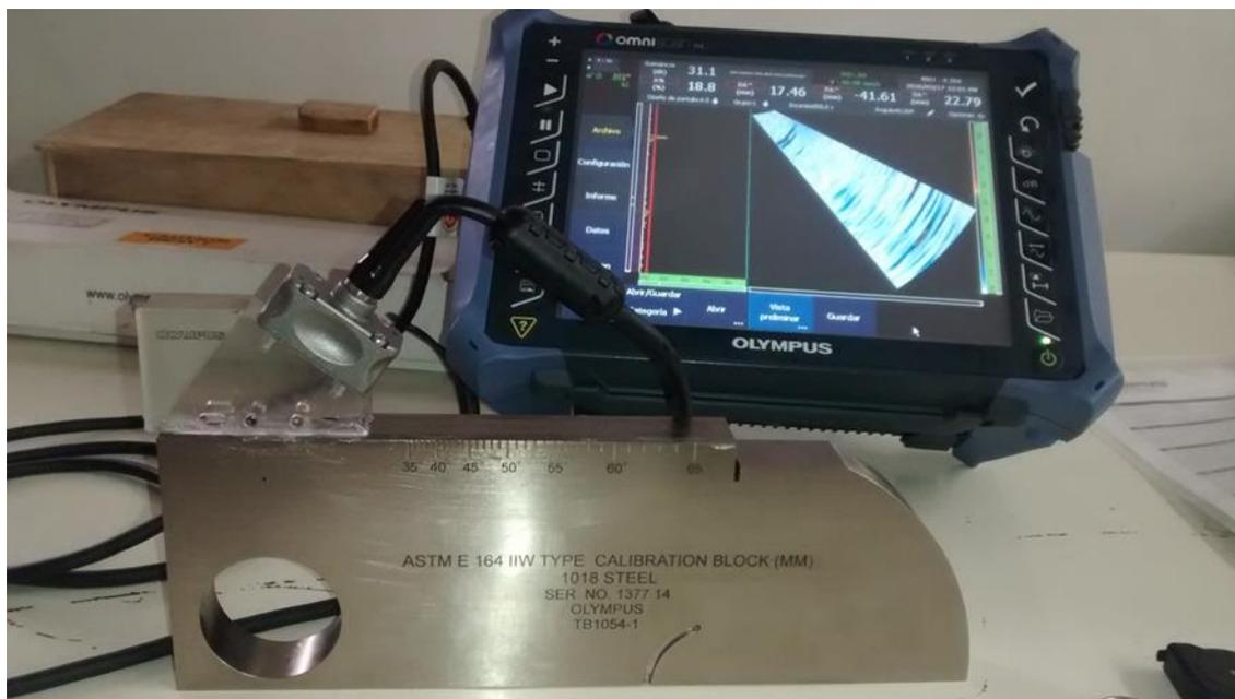
Figura 18. Equipo, palpador y placa de calibración IIV.
