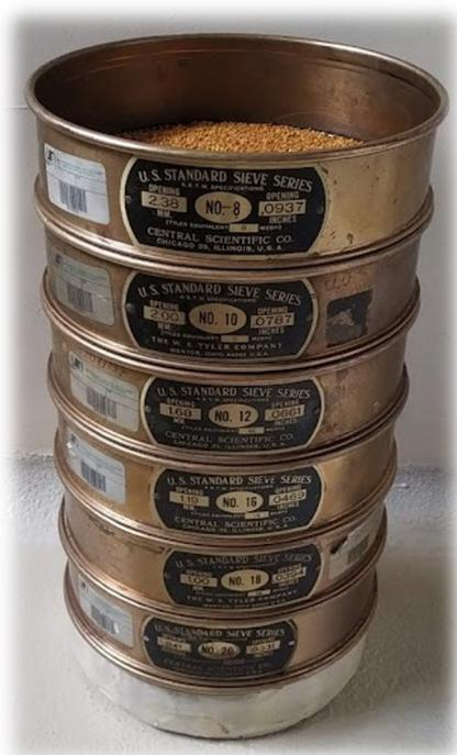
**Figura 2- 2:** Tamices usados para la separación del polen apícola
