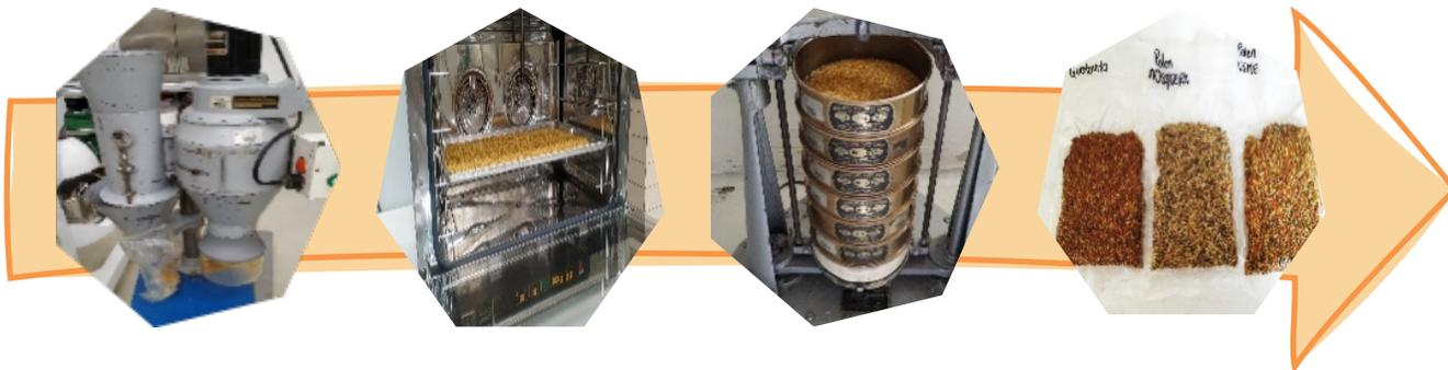
**Figura 2- 4:** Ciclonado, secado, tamizado y almacenamiento de polen apícola
