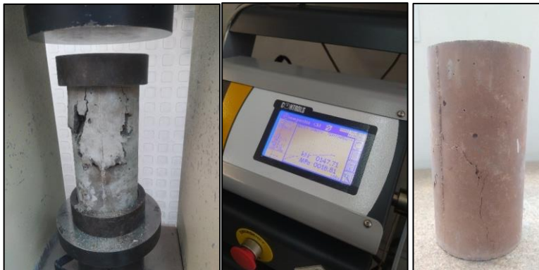
Figura 5-23: Ensayo de resistencia a la compresión en cilindros de concreto.
