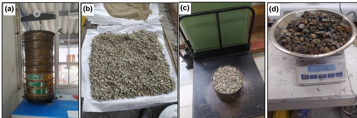
Figura 4-14: Caracterización de agregado grueso para concreto: (a) granulometría, (b) secado, (c) masa unitaria compacta y (d) peso saturado y superficialmente seco.
