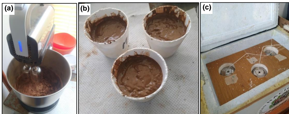
Figura 5-4: Ensayos de calor de hidratación: (a) mezclado de pasta de cemento, (b) especímenes de ensayo y (c) cámara semi adiabática.
