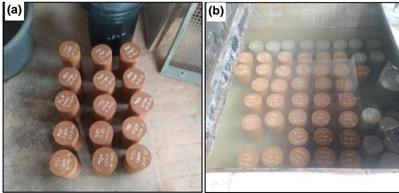
Figura 5-22: (a) desencofrado y marcaje y (b) curado en piscina de probetas de concreto.
