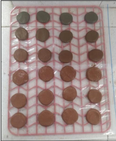
Figura 5-8: Probetas de pasta de cemento a carbonatar y para pruebas de DRX.
