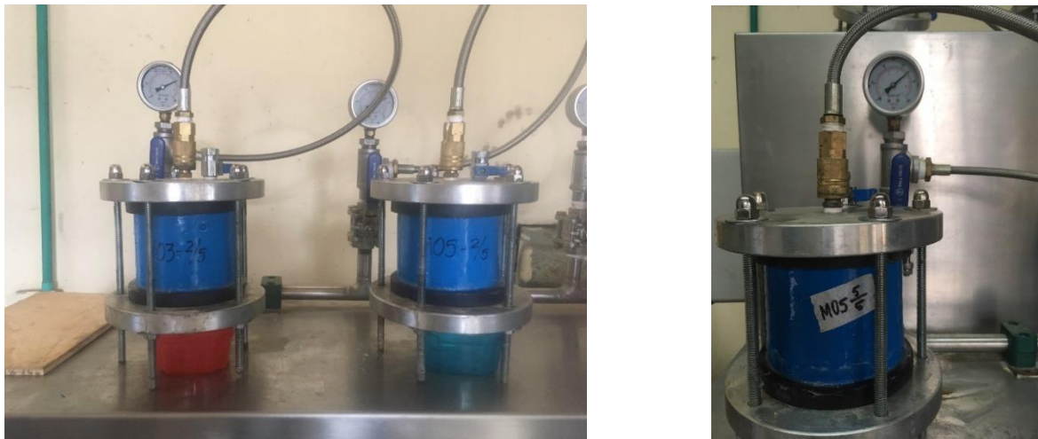
Figura 2-21 Montaje de probetas para ensayo de permeabilidad al agua
