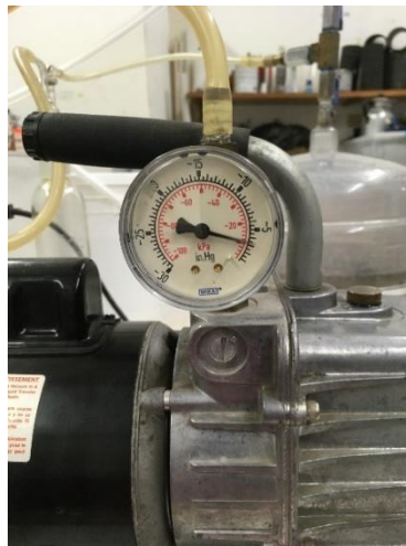
Figura 2-14 Lectura de la presión interna de la cámara de vacío mediante vacuómetro analógico.
