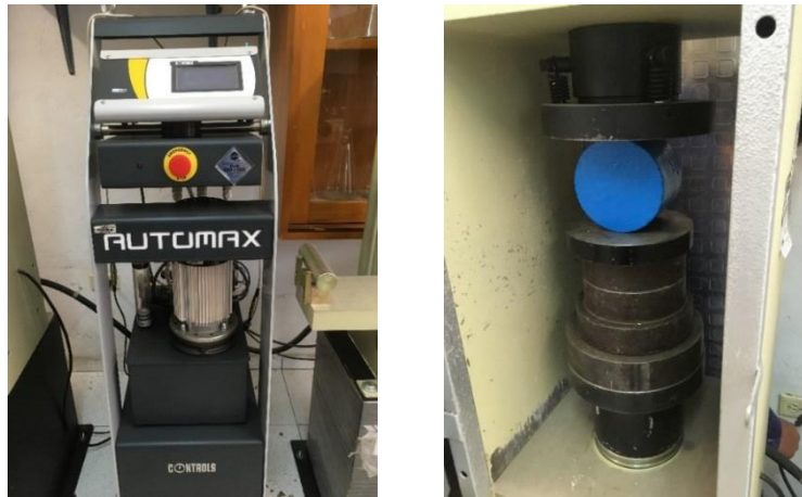
Figura 2-41 Prensa automax para partido de probetas de SPT.
