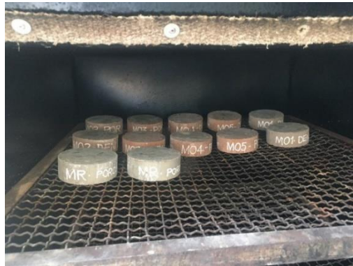
Figura 2-10 Secado de muestras para evaluación de porosidad y densidad
