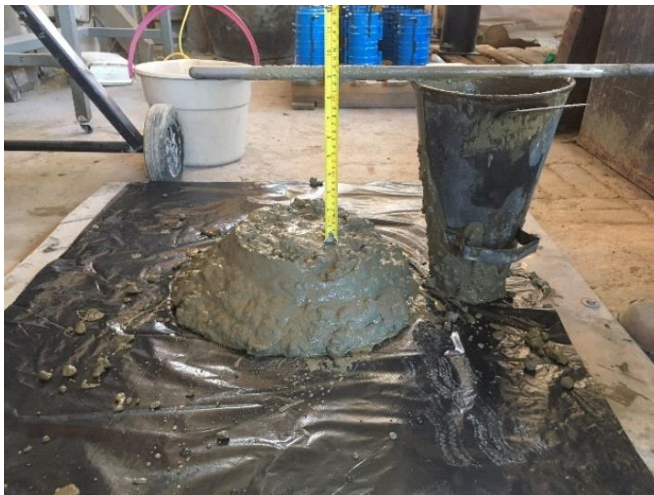
Figura 2-3 Asentamiento mezcla de referencia MR (8-1/2") y mezcla M01 (8-3/8").
