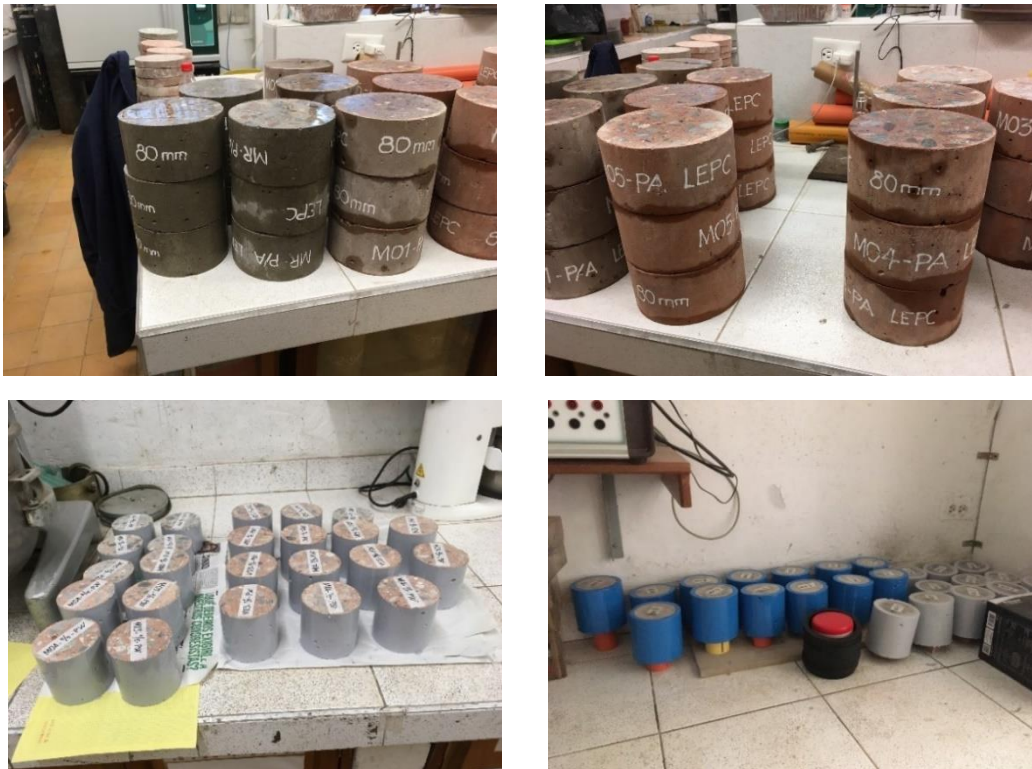
Figura 2-19 Alistado probetas para evaluación de la permeabilidad al agua.
