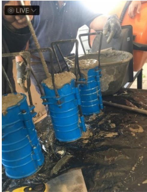
Figura 2-2 Llenado de moldes y compactado de la mezcla mediante varillado
