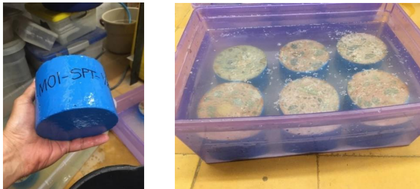
Figura 2-39 Preparación de probetas para ensayo SPT
