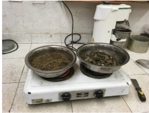
Figura 2-1 Secado de muestras de los agregados grueso y fino.
