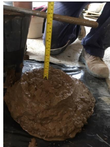
Figura 2-3 Asentamiento mezcla de referencia MR (8-1/2") y mezcla M01 (8-3/8").
