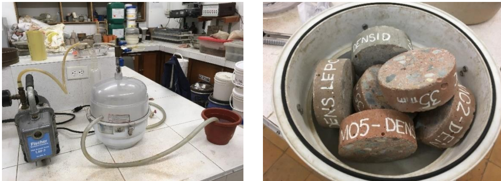
Bomba y cámara de vacío. Muestras en cámara de vacío. Fuente: propia.
