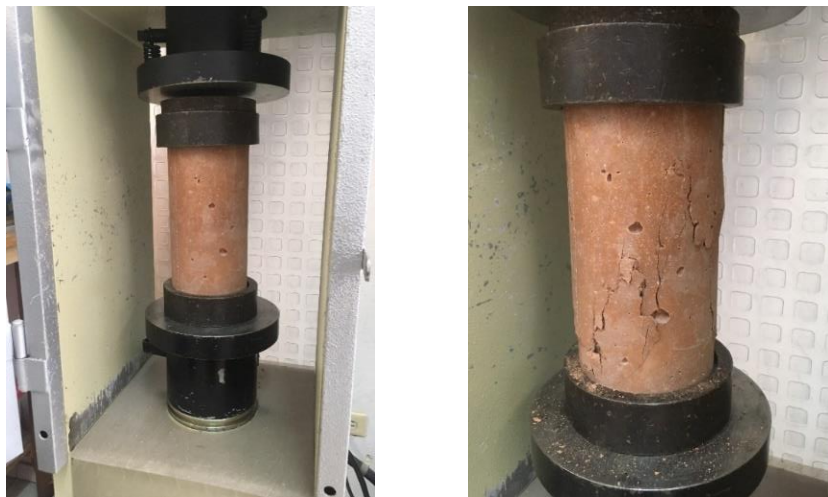
Figura 2-17 Montaje y rotura de probeta en ensayo de resistencia a la compresión
