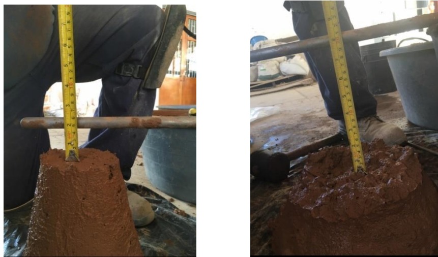
Figura 2-5 Asentamiento mezclas M04 (1-3/4") y M05 (7-5/8").
