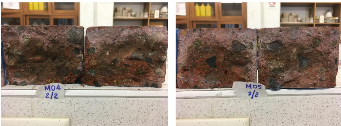
Figura 2-44 Profundidad penetración cloruros en ensayo SPT mezclas M04 y M05
