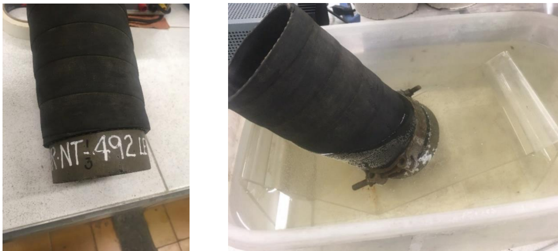
Figura 2-33 Montaje probeta en manga de caucho y colocación en solución catódica
