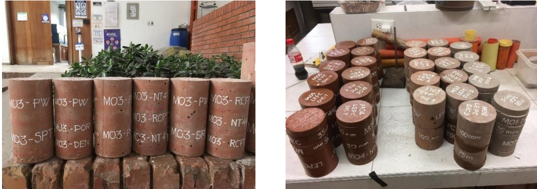
Figura 2-29 Marcado y corte de muestras para NT-492 y otros ensayos
