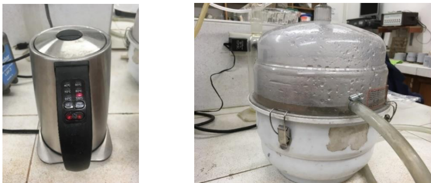
Figura 2-12 Hervido de agua potable y saturación de probetas
