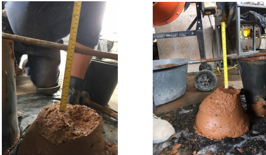
Figura 2-4 Asentamiento mezclas M02 (6-3/4") y M03 (5-1/8").
