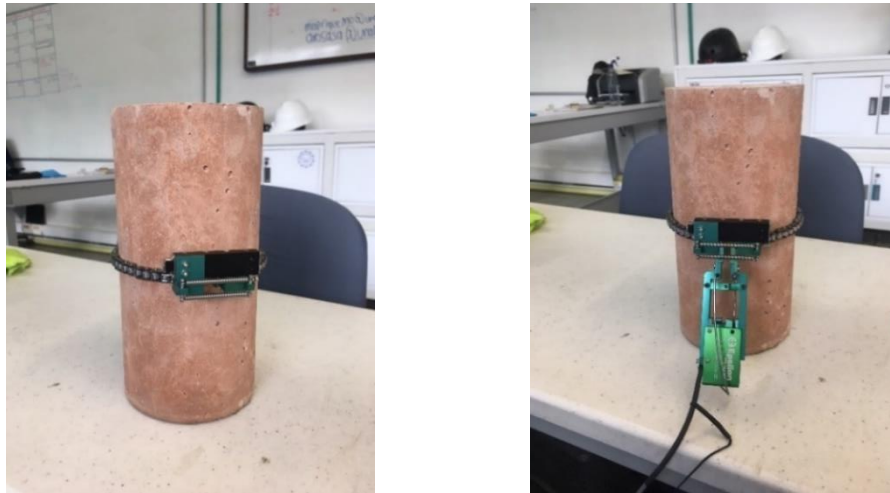
Figura 2-15 Acondicionamiento de probeta para evaluación del módulo de elasticidad.
