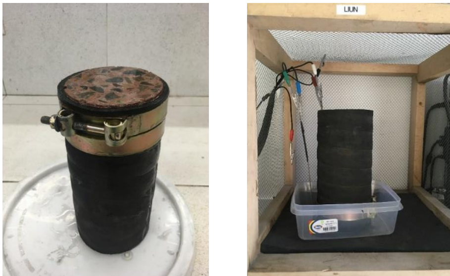
Figura 2-46 Preparación probeta para ensayo de electro impedancia EIS
