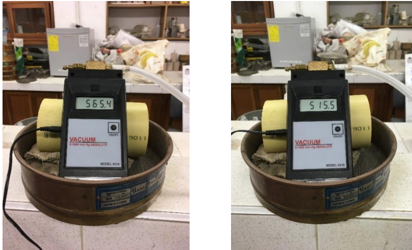
Figura 2-13 Lectura de la presión mediante Vacuómetro digital.
