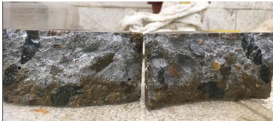
Figura 2-37 Frente de precipitación del nitrato de plata en ensayo NT BUILD-492.
