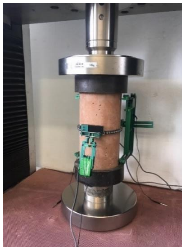
Figura 2-16 Instrumentación de muestra para evaluación del módulo de elasticidad.
