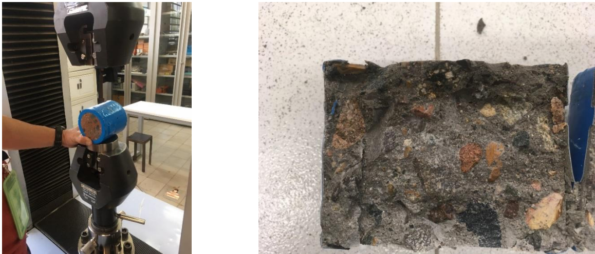
Figura 2-22 Partido probeta para permeabilidad al agua.
