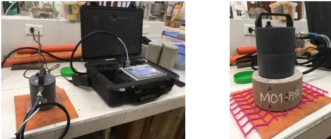
Figura 2-25 Equipo permeaTORR y celda de vacío listos para inicio de lectura
