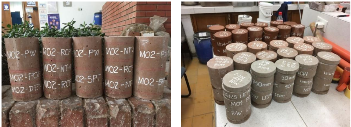
Figura 2-8 Muestras identificadas, marcadas y cortadas con disco diamantado
