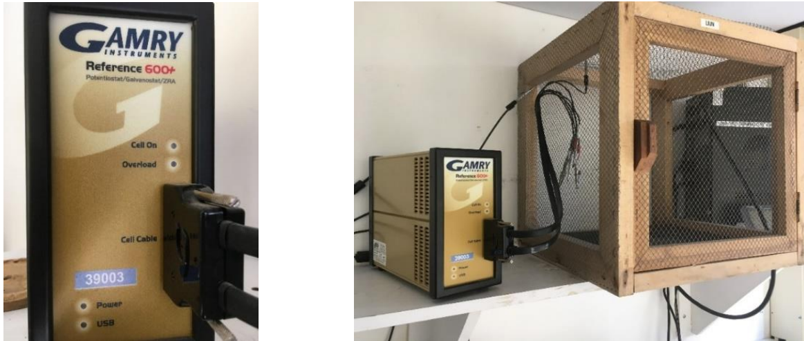
Figura 2-45 Potenciostato Gamry 600+ y celda de Faraday para prueba EIS
