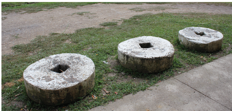
Juego de piedras (mayalera y orilleras) abandonadas, de un trapiche de madera y piedra.
