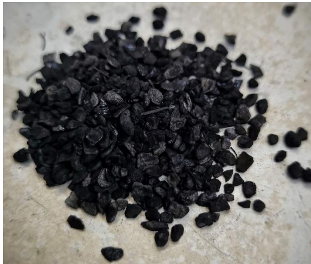
Carbón activado obtenido en atmósfera de vapor de agua durante 2 horas, a partir del biochar de pirólisis a 700^\circ\text{C}
