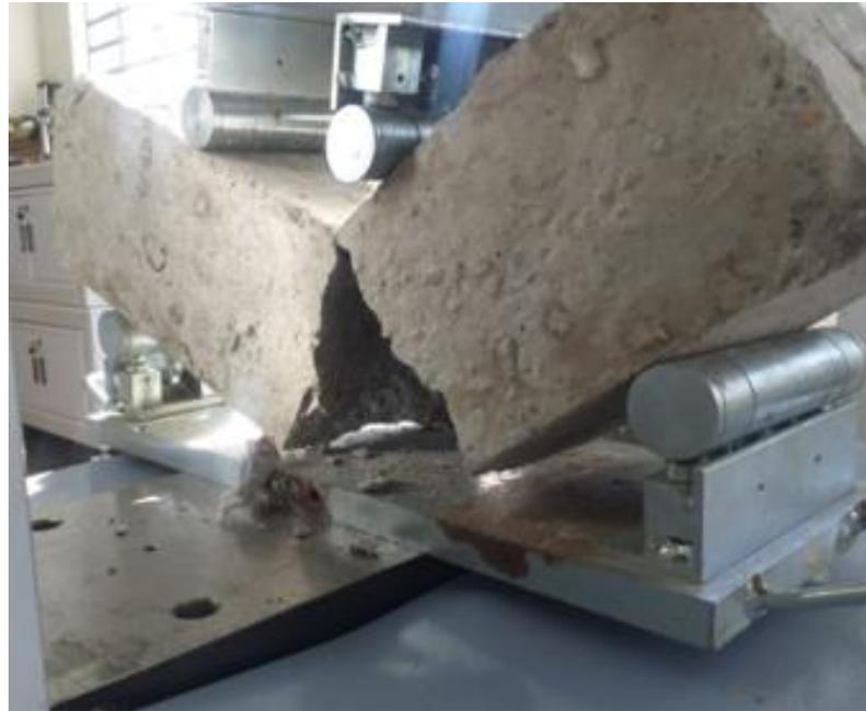
**Figura 3-22:** Secuencia de falla típica de las vigas del compuesto concreto/epóxico-fique.
