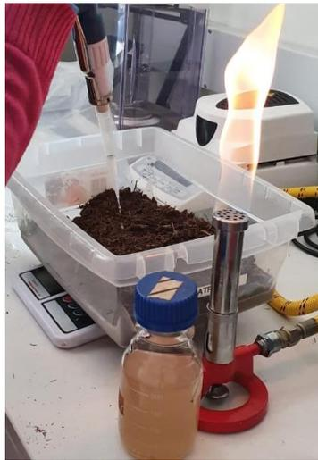
Figura 1. Inoculación del lecho de biofiltración
