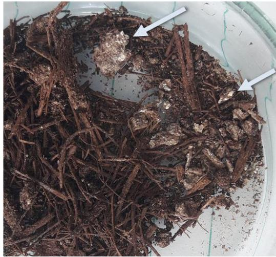
**Figura 3.** Lecho de compost al finalizar el ensayo. Se indica la presencia de precipitados blancos formados por la precipitación de sales (flecha blanca).
