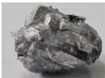
Figura 3.13. Ejemplo del tipo de muestras que se pueden obtener a partir de la técnica de flujo. Esta muestra corresponde al compuesto GdFe_2Al_{10} y fue fabricada en el proyecto.
