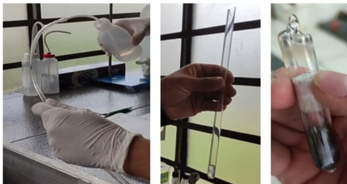
Figura 3.14. Proceso de fabricación del crisol artesanal con recubrimiento interno de carbono y ampolla finalizada.
