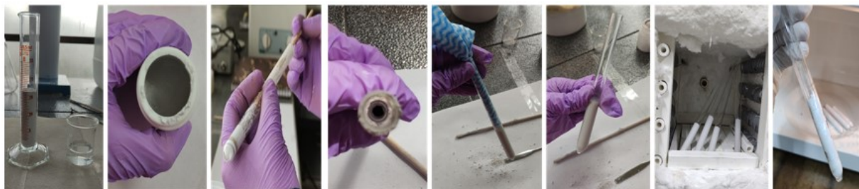
Figura 3.15. Proceso de fabricación del crisol artesanal con recubrimiento interno de alúmina y agua.
