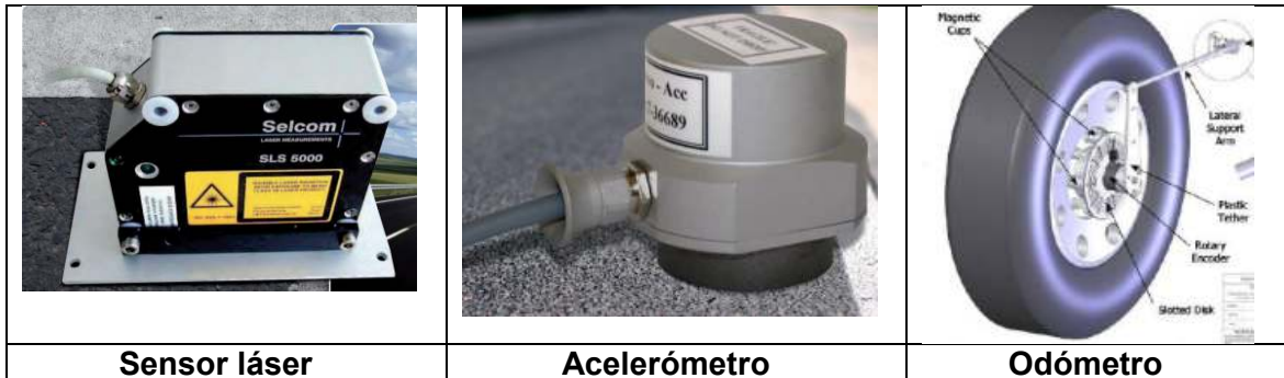
Figura 1-8: Partes de perfilómetro láser
