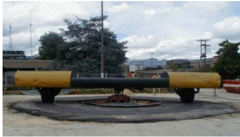
Figura 1-34: Carrusel de fatiga Universidad de los Andes
