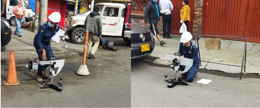
Figura 2-14: Fotografía medición péndulo ingles
