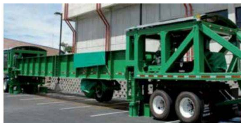
Figura 1-33: Simulador de Vehículos Pesados (LANAMME)
