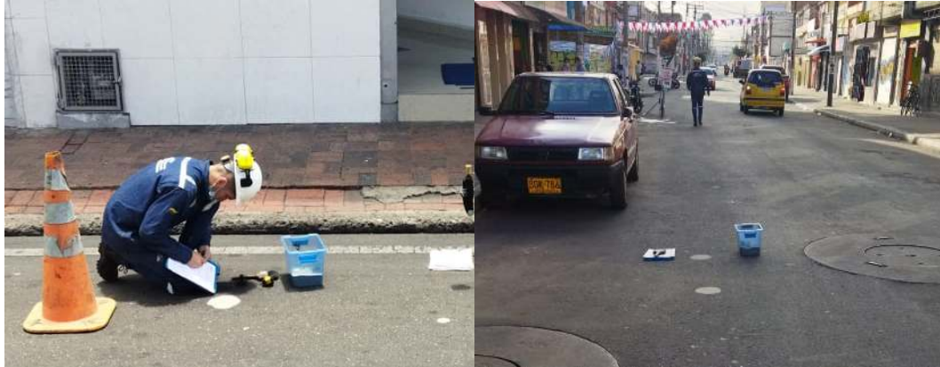
Figura 2-11: Fotografía medición círculo de arena
