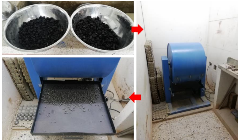
Figura 3-9. Ejecución de ensayo de resistencia a degradación en Maquina de Los Ángeles.
