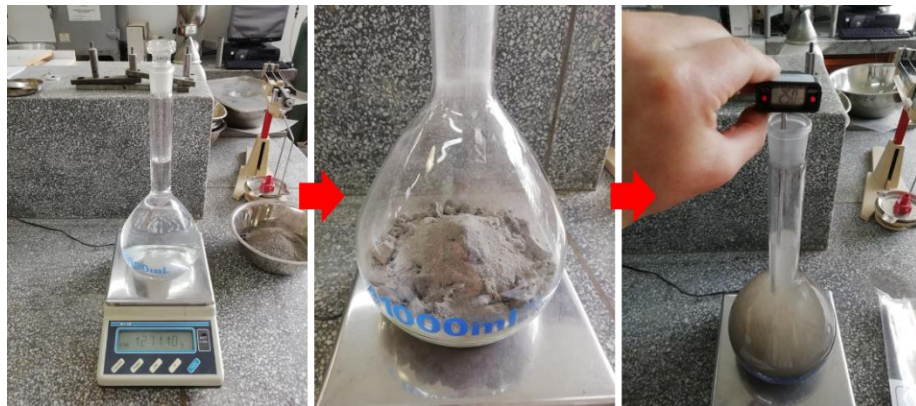
Figura 3-12. Ejecución de ensayo de gravedad específica para gradación completa de la ECSD (Laboratorio de Geotecnia - UNAL).
