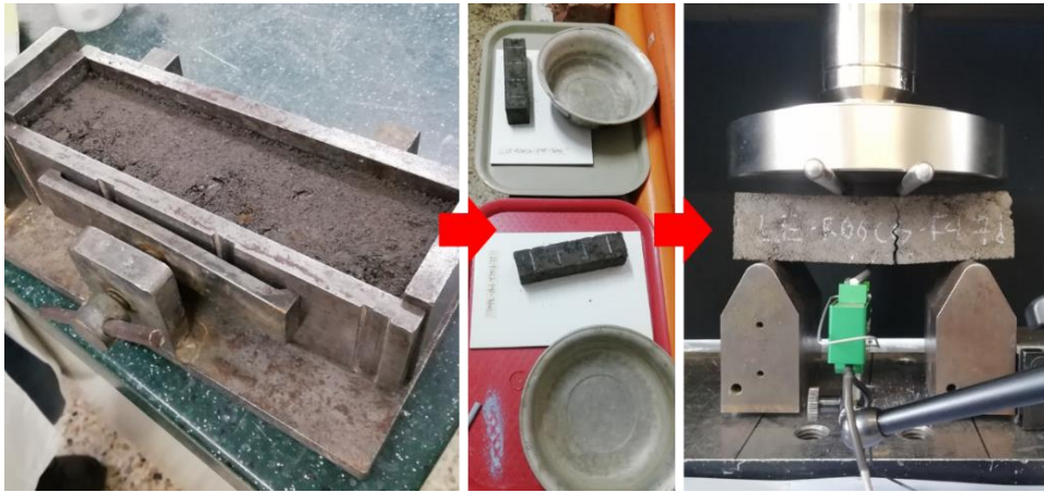
Figura 3-25. Ejecución de ensayos de flexión (Laboratorio de Estructuras - UNAL).
