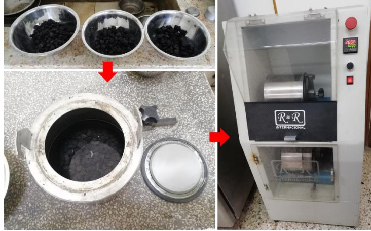
Figura 3-10. Ejecución de ensayo de resistencia por abrasión en Aparato Micro Deval (Laboratorio de Geotecnia - UNAL).
