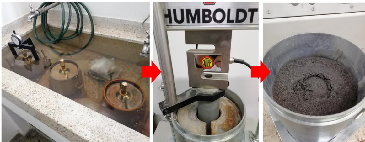
Figura 3-18. Ejecución de ensayos CBR sobre ECSD (Laboratorio de Geotecnia - UNAL).
