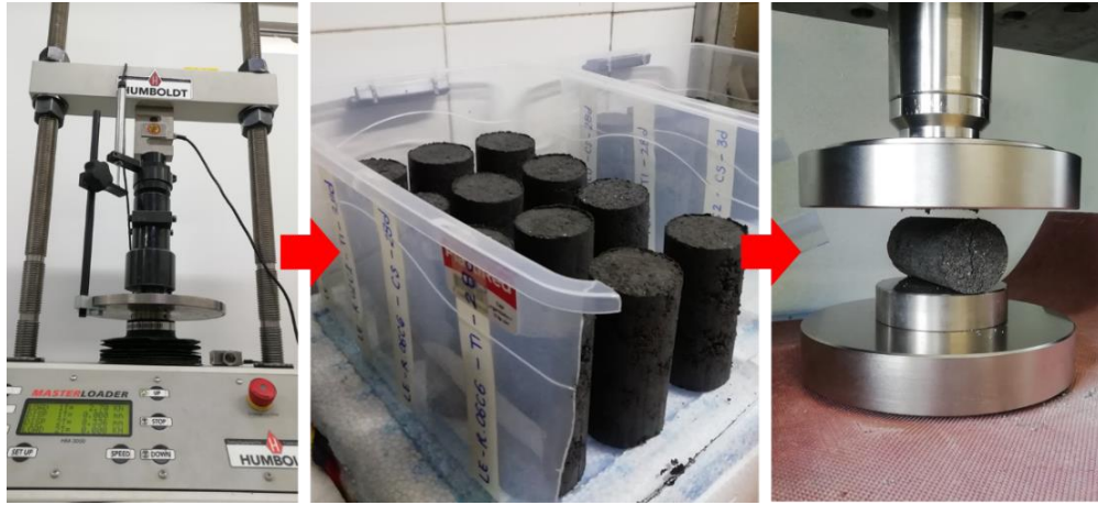
Figura 3-24. Ejecución de ensayos en tracción indirecta (Laboratorio de Estructuras - UNAL).
