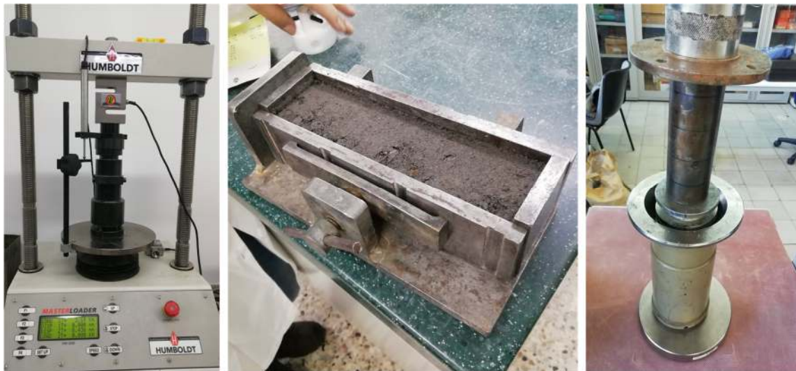
Figura 2. Equipos y moldes para proceso de compactación de muestras (Laboratorio de Estructuras – UNAL)
