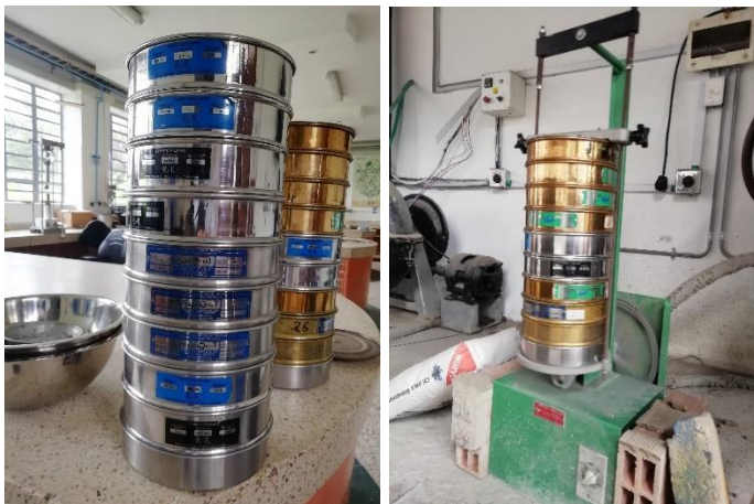
Figura 1-10. Tamizado para determinación de granulometría de materiales.
