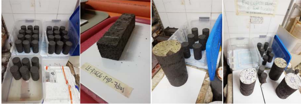
Figura 3. Muestras en curado en cuarto húmedo. (Laboratorio de Geotecnia – UNAL).
