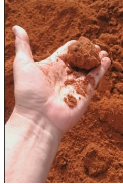
Figura 589. Prueba manual de manejabilidad de la mezcla. Barichara.
