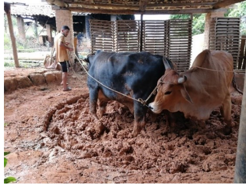
Figura 449. Amasado de barro con bueyes, Chircal de Los Romero, vereda Guayabal, Barichara.
