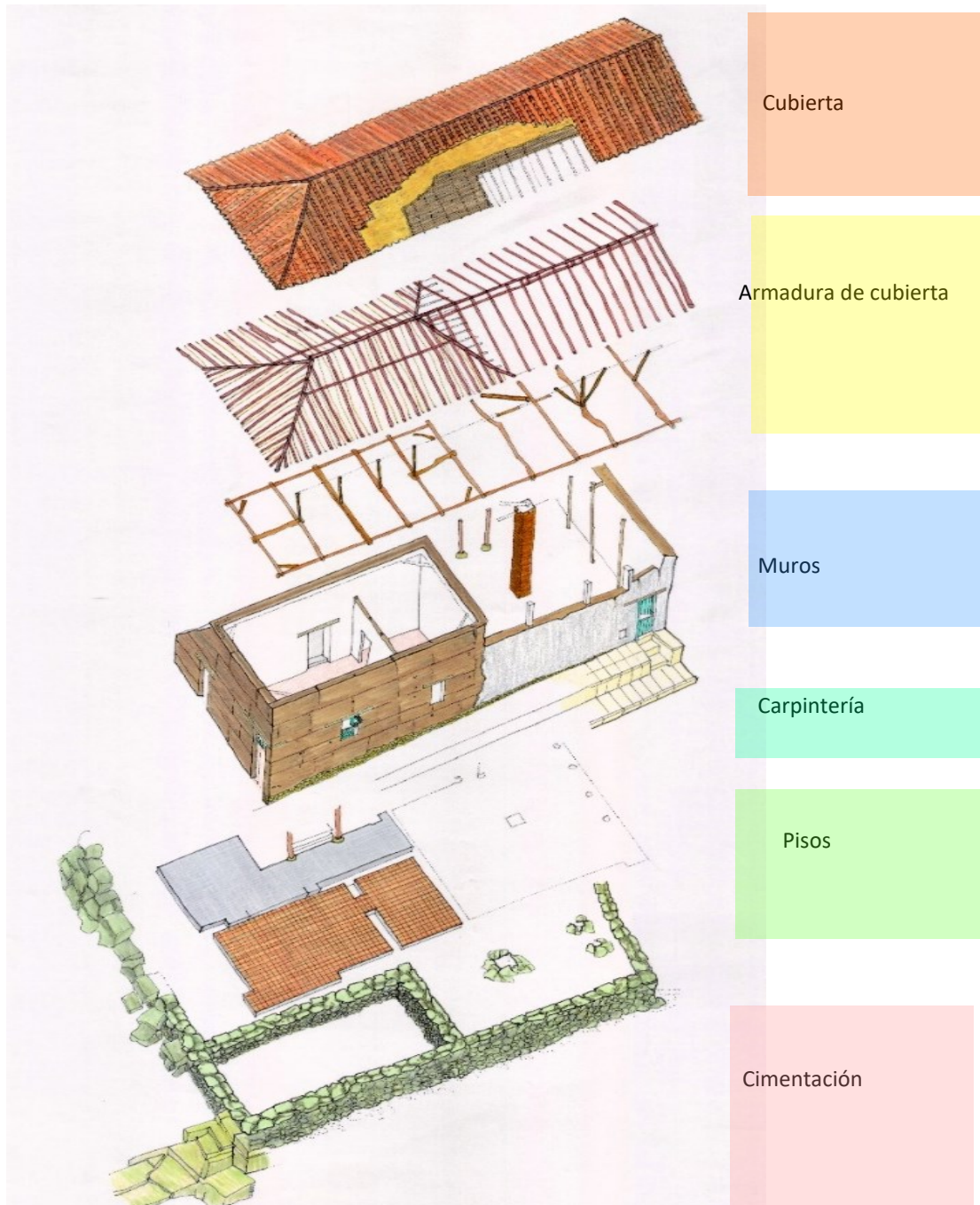
Figura 454. Esquema isométrico de construcción en tapia pisada
