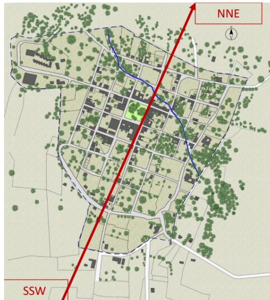
Figura 53. Dirección predominante de los vientos coincidiendo con la orientación de las vías longitudinales del centro poblado. Adaptado de Google Earth y EOT Cabrera 2000-2009.
