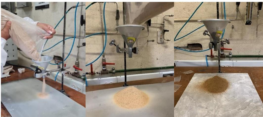
**Figura 2.6.** Prueba de embudo para las biomásas. Fuente: propia.
