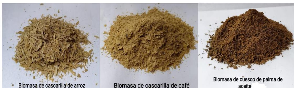
**Figura1.3.** Biomasa seleccionadas para el proceso de pirólisis rápida en el reactor Auger. Fuente: propia.
