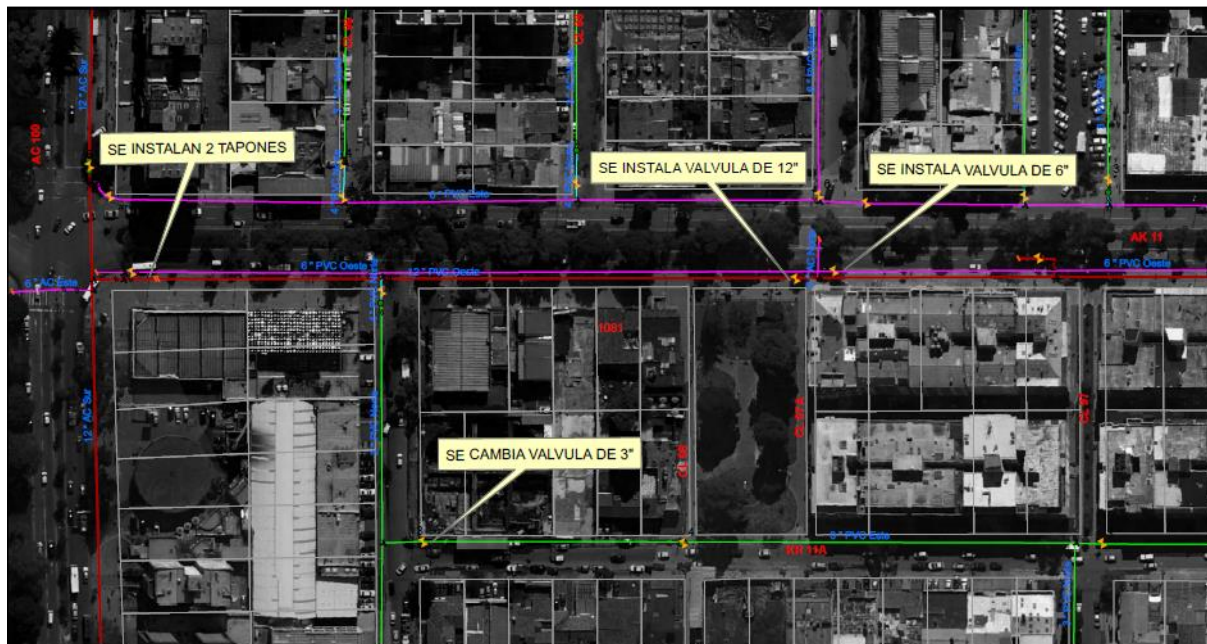
Figura 8-17: Trabajos realizados para el control de suministro de agua.
