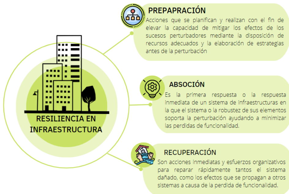
Figura 3-2: Fases de la resiliencia en infraestructura.
