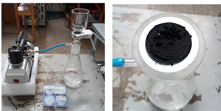
Figura 4 - 3: proceso de filtrado al vacío.
