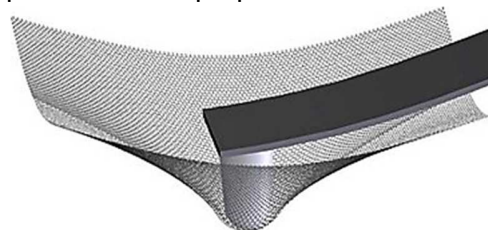
Figura 1 - 11: técnica de indentación sobre una capa de grafeno mediante un microscopio de fuerza atómica (AFM) para medir las propiedades mecánicas del grafeno. [40].
