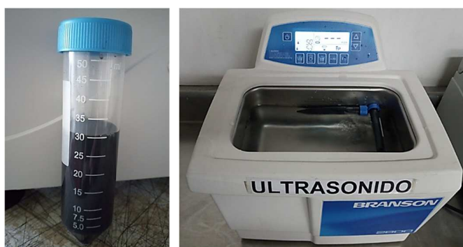
Figura 4 - 4: técnica de sonicación con un baño ultrasónico Branson 2400.
